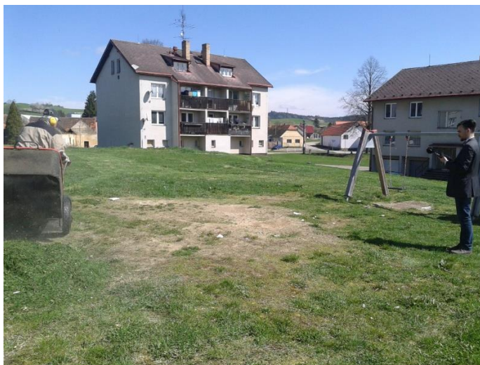
Obrázek 24 – Měření hluchnosti zahradního traktoru při práci
