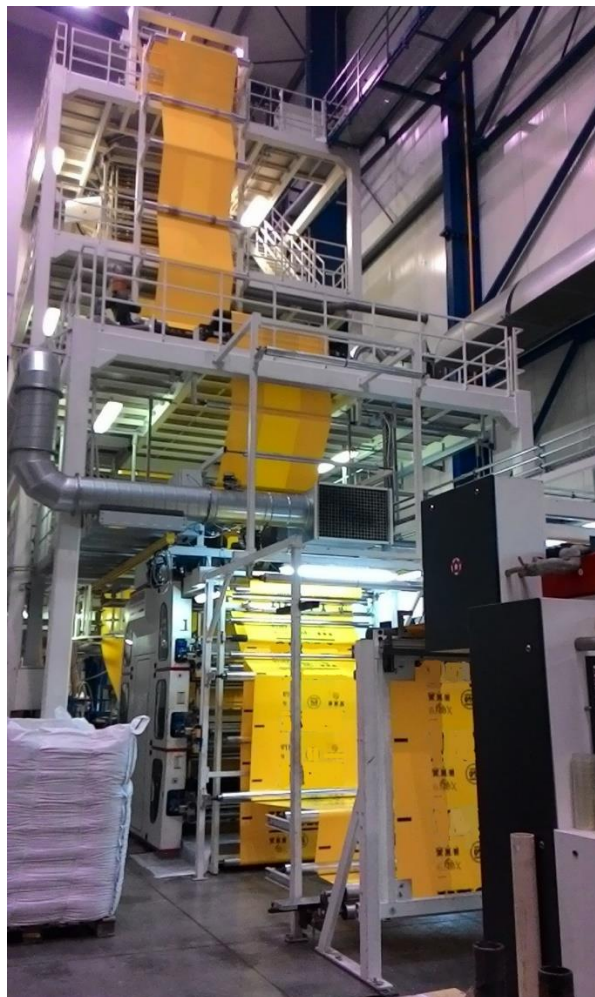
Obrázek č. 20: Extrudér s online osmibarevným tiskem (Zdroj: vlastní zpracování)
