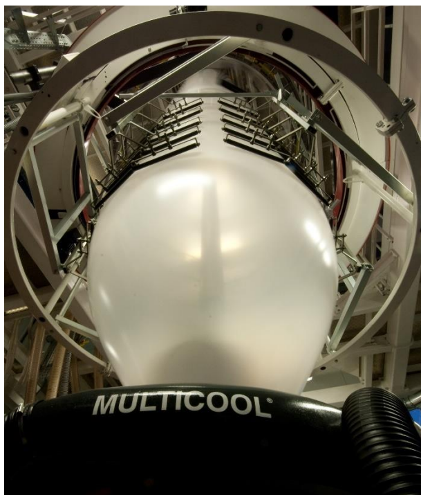
Obrázek č. 19: Proces vyfukování fólie
