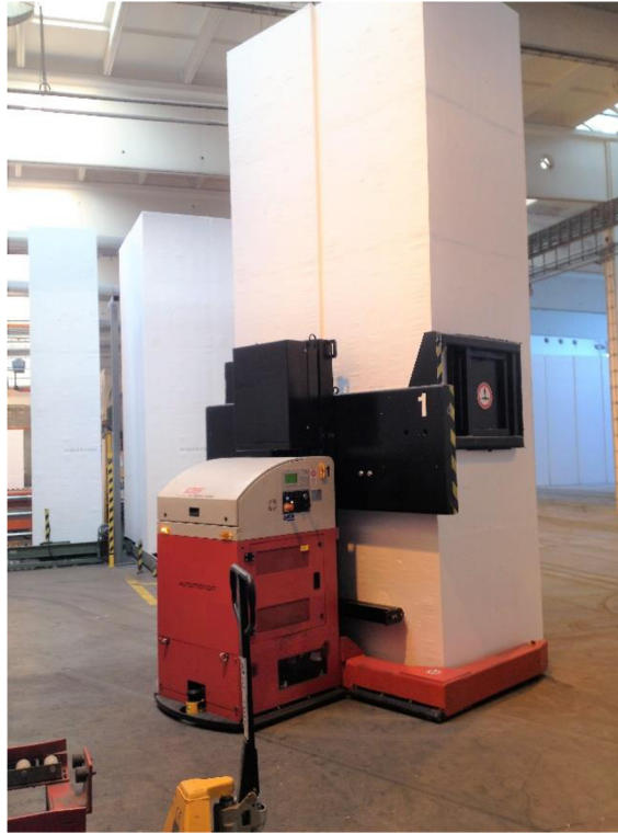
Obrázek č. 17: Automatizovaný systém dopravy bloků
