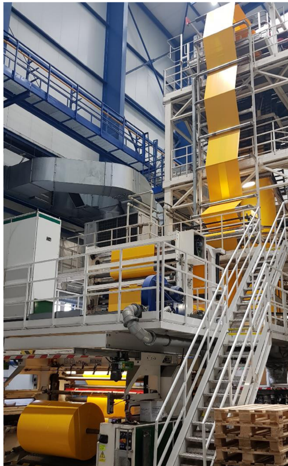
Obrázek č. 16: Extrudér na PE balicí fólie s osmibarevným tiskem (Zdroj: interní dokumenty společnosti)
