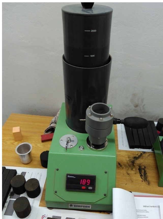
Obrázek 4.2: měří přístroji PDU-D Digital Permeability Meter
