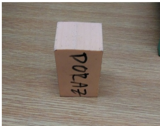
Obrázek 4.4: Univerzální doraz z umělého dřeva (necuron 650)
