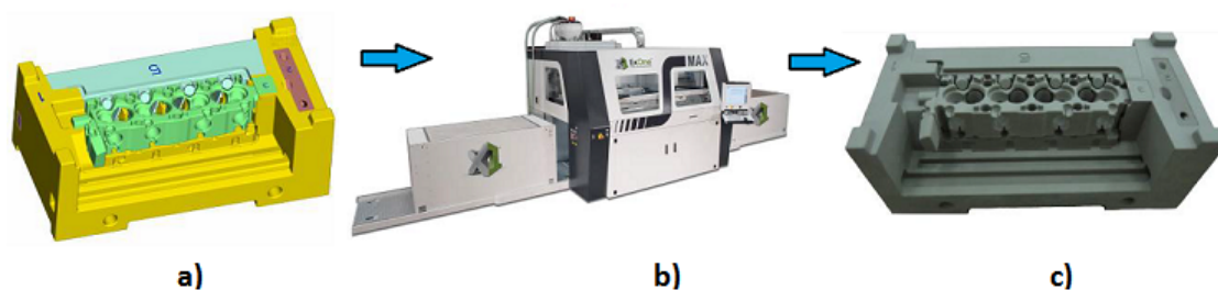
Obrázek 3.1: ukázka výroby pískové formy: a) model ve formátu STL b) 3D tiskárna ExOne S-Max c) vytištěný fyzický model
