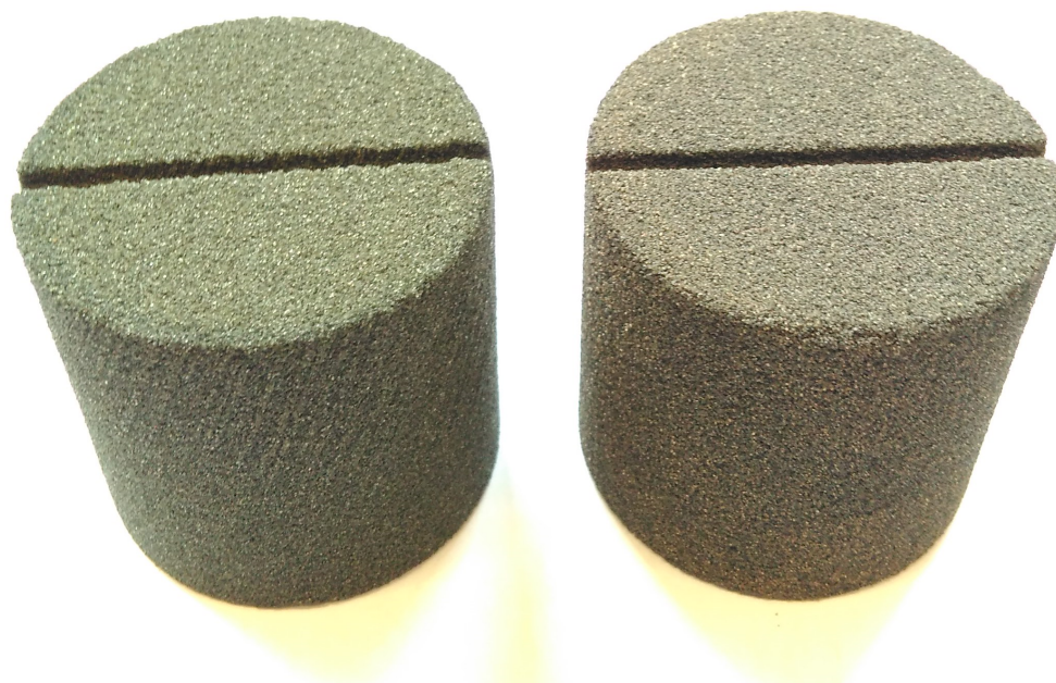
Obrázek 4.11: Vliv vyššího množství pojiva (vzorek vlevo) na měřený vzorek při 20° poloze
