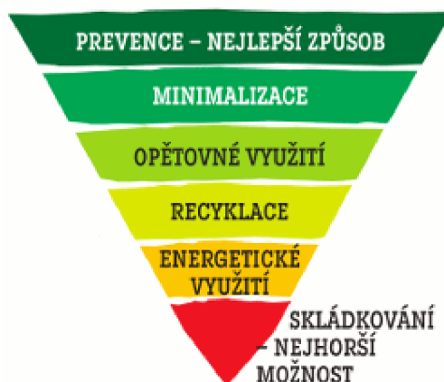
Obr. 1.1: Hierarchie nakládání s odpady [2]
