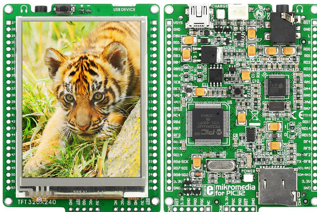
Obrázek 4-3 Foto vývojové desky Mikromedia for PIC32
