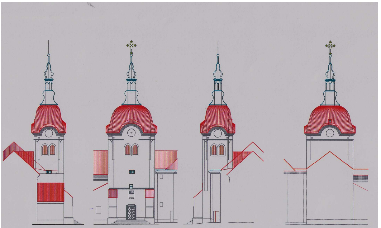
Nákres Ing. Černého na výměnu střešní krytiny na věži v r. 2010
