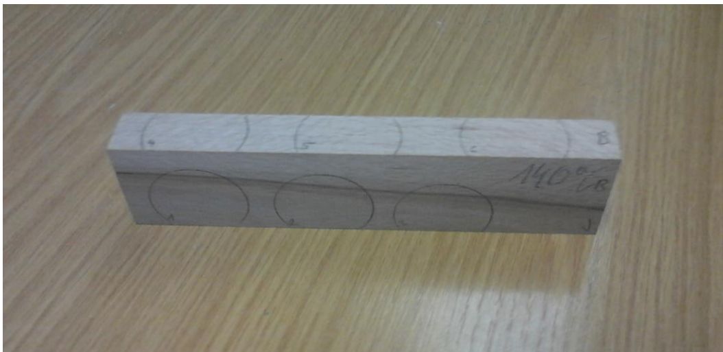
Obr. 9 – Rozvržení zón měření pro spektrofotometr
