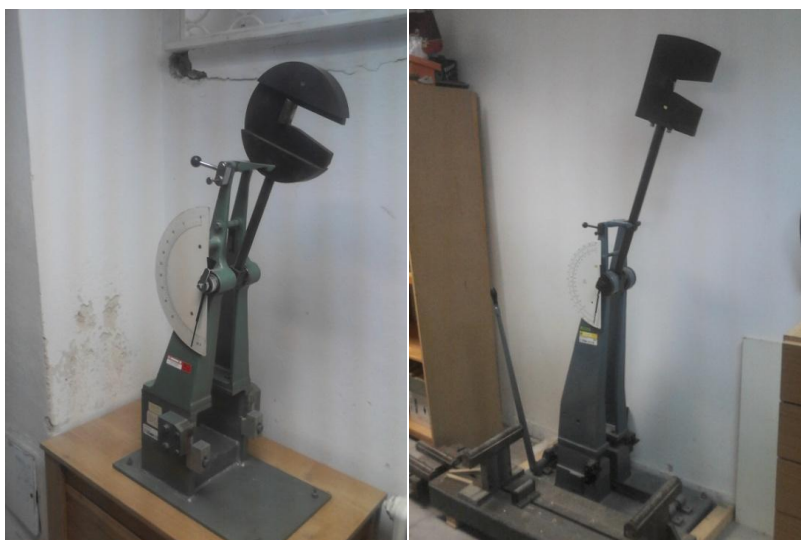
Obr. 11 – Přerážecí Charpyho kladiva se stupnicí a hlavami na 50 J a 150 J.
