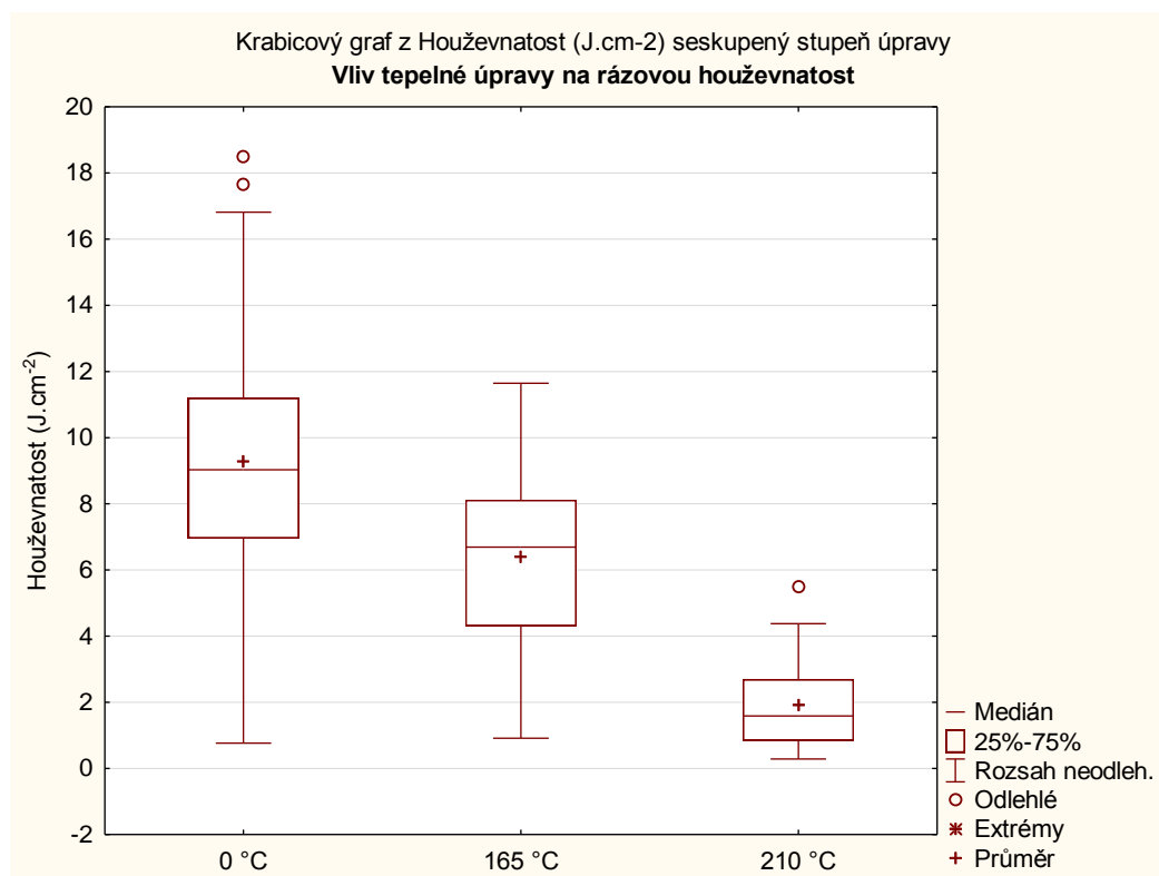
Graf 10 – Vliv tepelné úpravy na rázovou houževnatost
