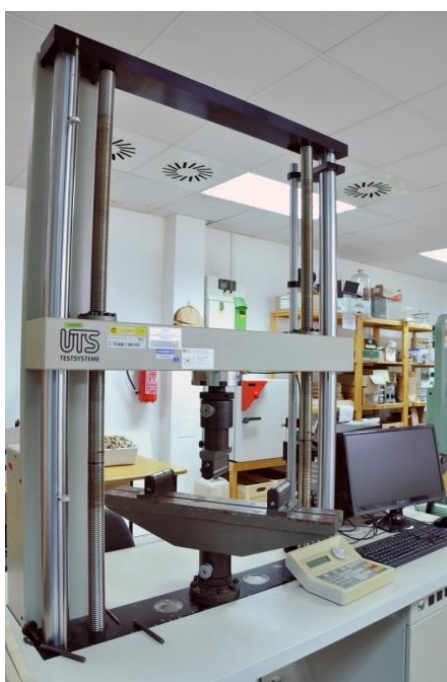
Obr. 12 – Zkušební stroj UTS 50 uzpůsobený pro ohybové zkoušky
