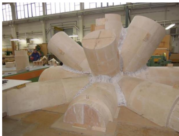
Obr. 4 Dřevěný model spojky ropovodu [7]
