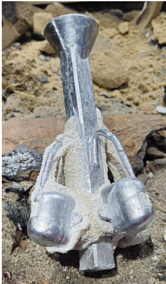
Obr. 28 Částečně očištěný stromeček s odlitky
