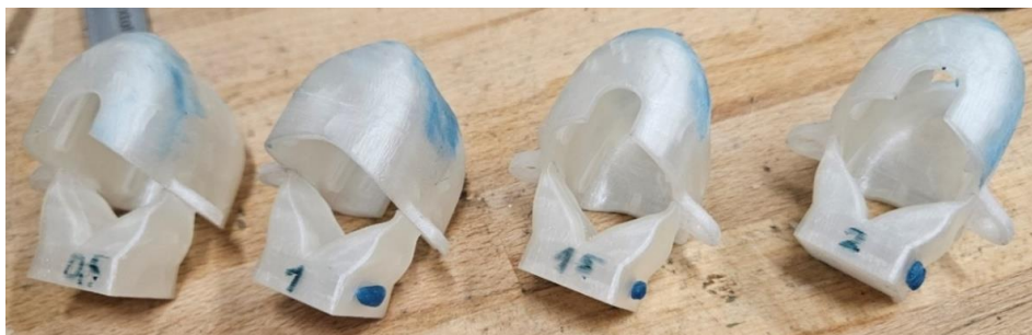
Obr. 22 Modely lišící se o hodnotu smrštění
