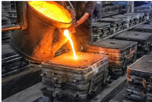
Obr. 6 Odlévání do netrvalé pískové formy [11]
