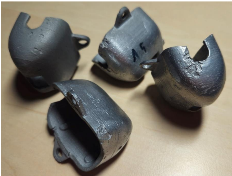
Obr. 30 Odlitky s vadným povrchem
