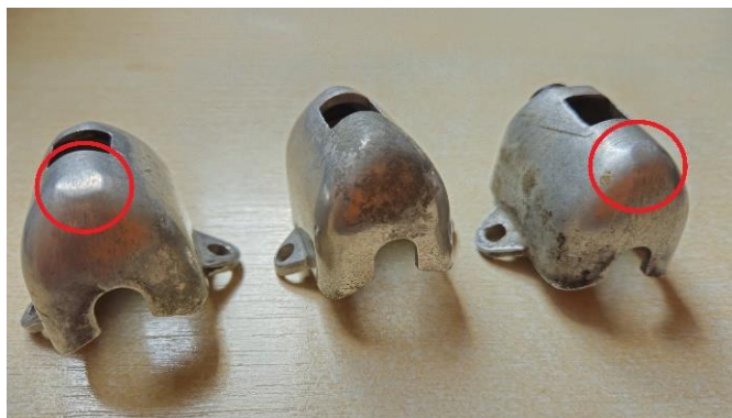
Obr. 2 Typické vady vnějšího povrchu
