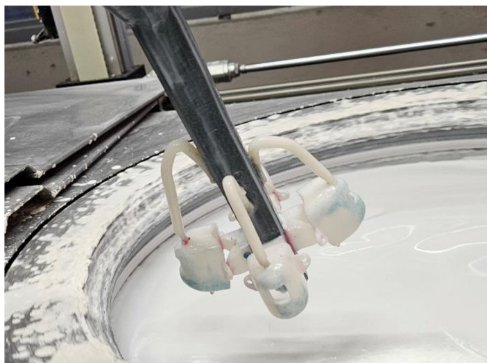
Obr. 24 Namáčení stromečku v suspenzi
