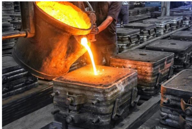
Obr. 6 Odlévání do netrvalé pískové formy [11]
