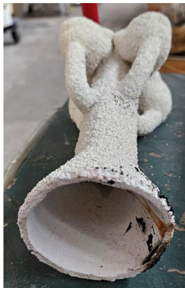
Obr. 27 Skořepina po procesu žihání
