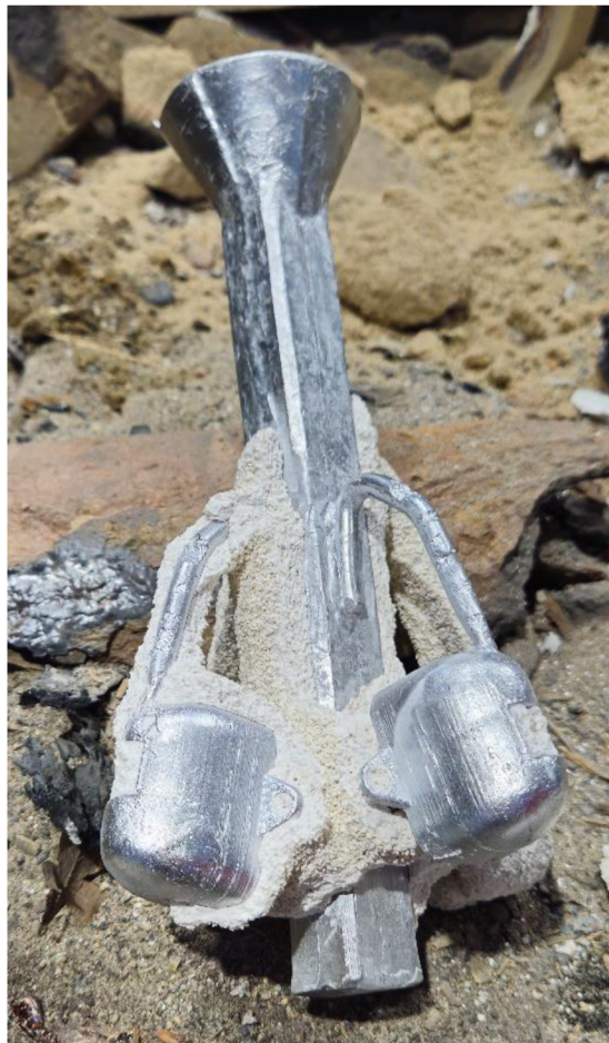
Obr. 28 Částečně očištěný stromeček s odlitky
