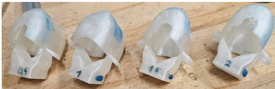
Obr. 22 Modely lišící se o hodnotu smrštění
