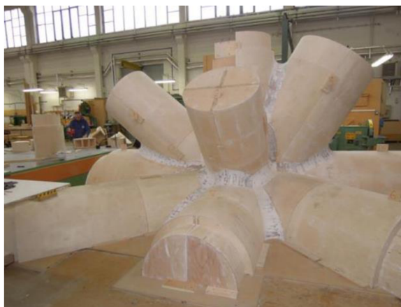
Obr. 4 Dřevěný model spojky ropovodu [7]
