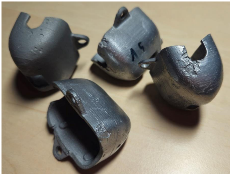
Obr. 30 Odlitky s vadným povrchem
