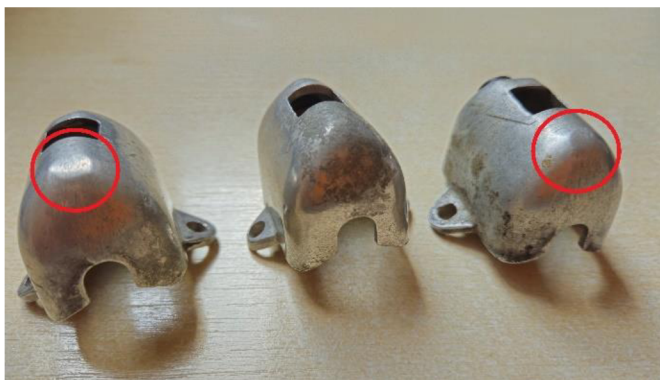
Obr. 2 Typické vady vnějšího povrchu
