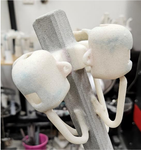
Obr. 25 První vrstva skořepiny
