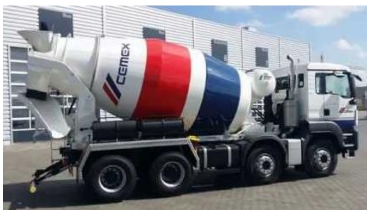
Obrázek 6 – Autodomíhávač MAN TGS 35.400 BB 8x4 s nástavbou Stetter AM 9 FHC Ultra Eco. [3]
