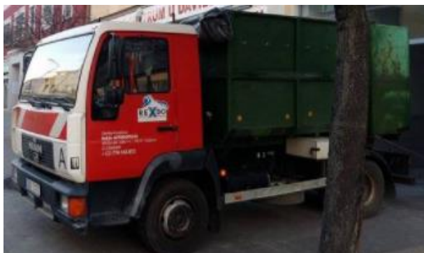
Obrázek 8 - Man pro odvoz a přívaz kontejnerů pro staveništní odpad. [6]
