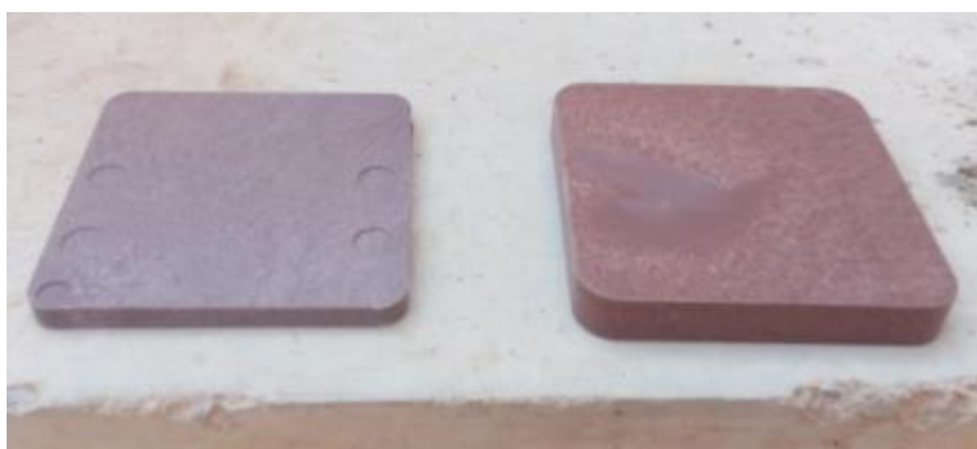
Obrázek 7 - Ukázka podložek pod schodišťová ramena.
