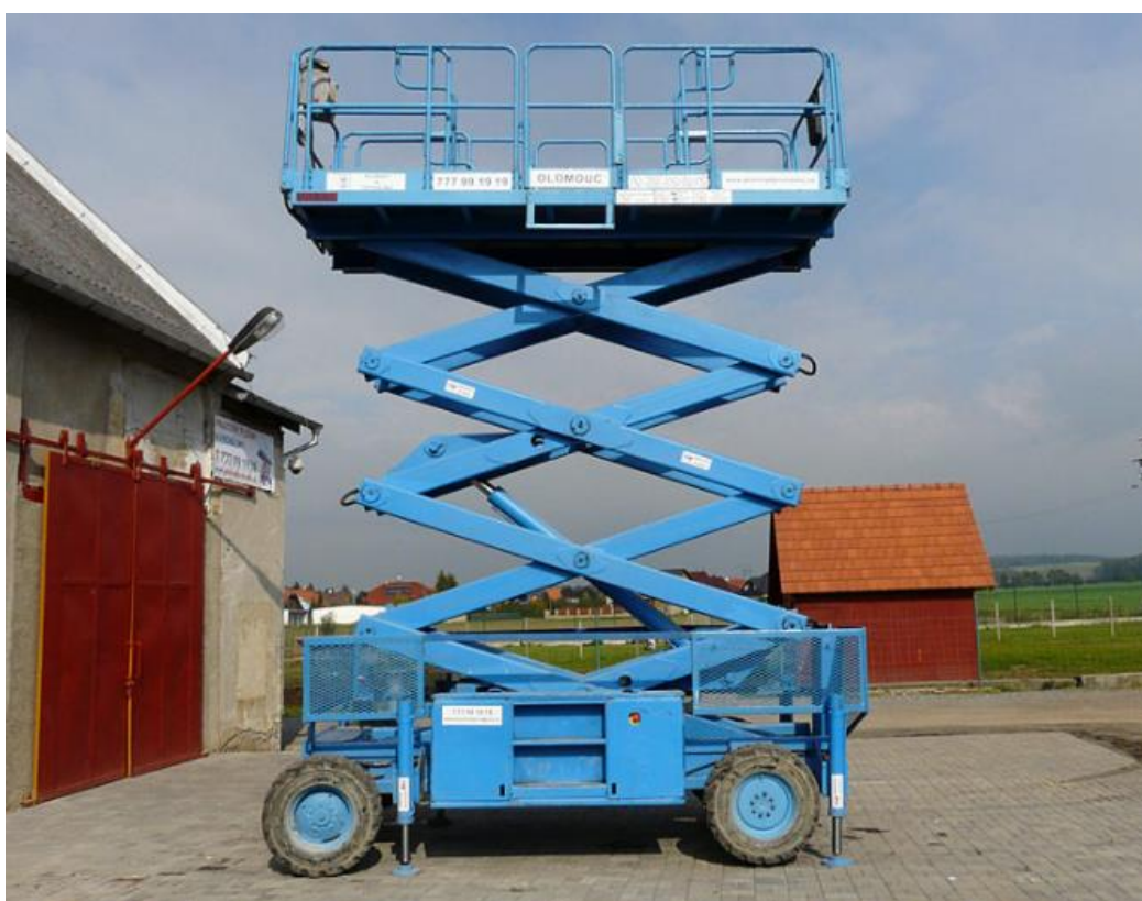
Obrázek 29 - Nůžková montážní plošina LX 50 4WD DD. [3]
