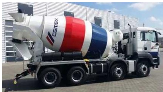
Obrázek 17 – Autodomíchač MAN TGS 35.400 BB 8x4 s nástavbou Stetter AM 9 FHC Ultra Eco. [6]
