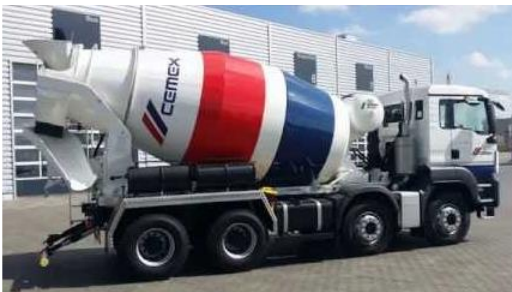
Obrázek 6 - MAN TGS 35.400 BB 8x4 s nástavbou Stetter AM 9 FHC Ultra Eco. [30]
