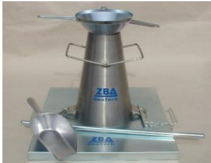
Obrázek 3 - Pracovní pomůcky pro zkoušku sednutí kužele.
