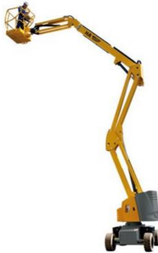
Obrázek 22 - Kloubová montážní plošina HA 15 IP. [5]
