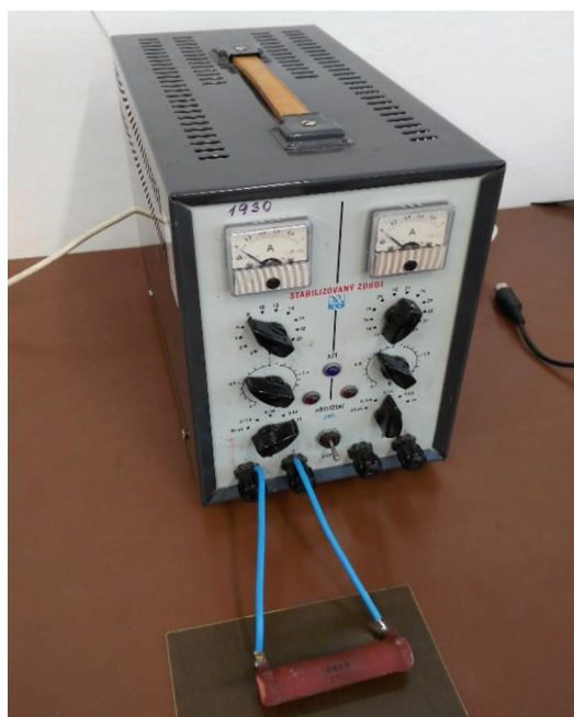
Obr. 35 Zdroj s odporem
