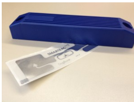
Obrázek 4 Pasivní a aktivní tag
