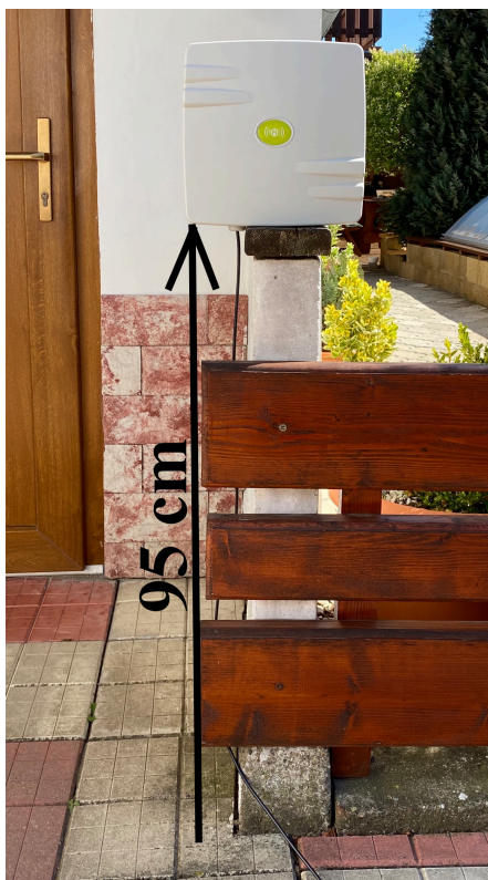
Obrázek 15 Ukázka upevnění RFID antény
