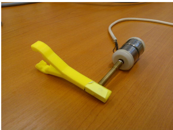
Obrázek 7: Držák vzorku připevněný na elektrodynamický vibrátor.
