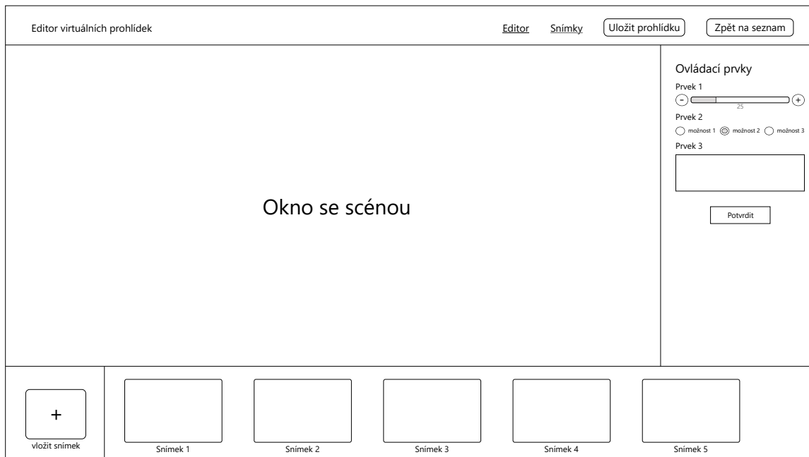
Obrázek 6.2: Návrh editoru virtuálních prohlídek. V horní části se nachází menu s prvky pro navigaci a uložení prohlídky. Pod menu v levé části je hlavní okno se scénou, kde je zobrazena právě editovaná scéna. Na pravé straně je umístěn ovládací panel s ovládacími prvky. Ve spodní části aplikace se nachází panel se seznamem scén pro výběr editované scény a tlačítko pro přidání scény do prohlídky na levé straně.
