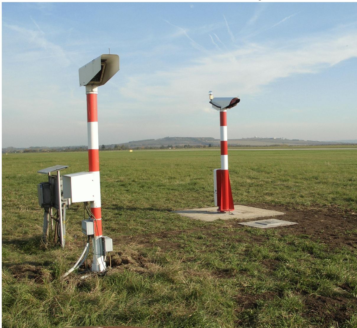
Obr. 5 Transmisometr MITRAS (nalevo) a transmisometr LT31 (napravo)
