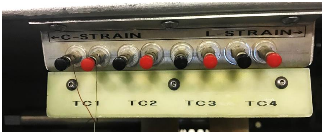
Obr. 2.11 Termočlánekové kanály přístroje Gleeble [19]
