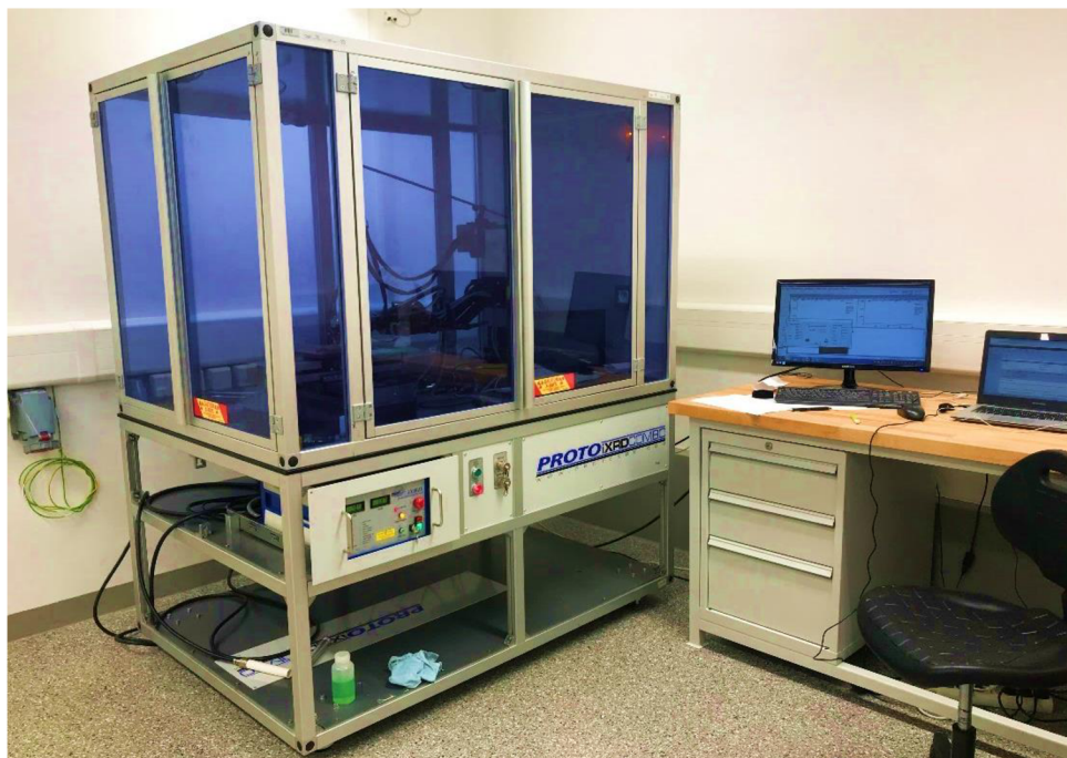
Obr. 3.4 Přístroj PROTO iXRD COMBO
