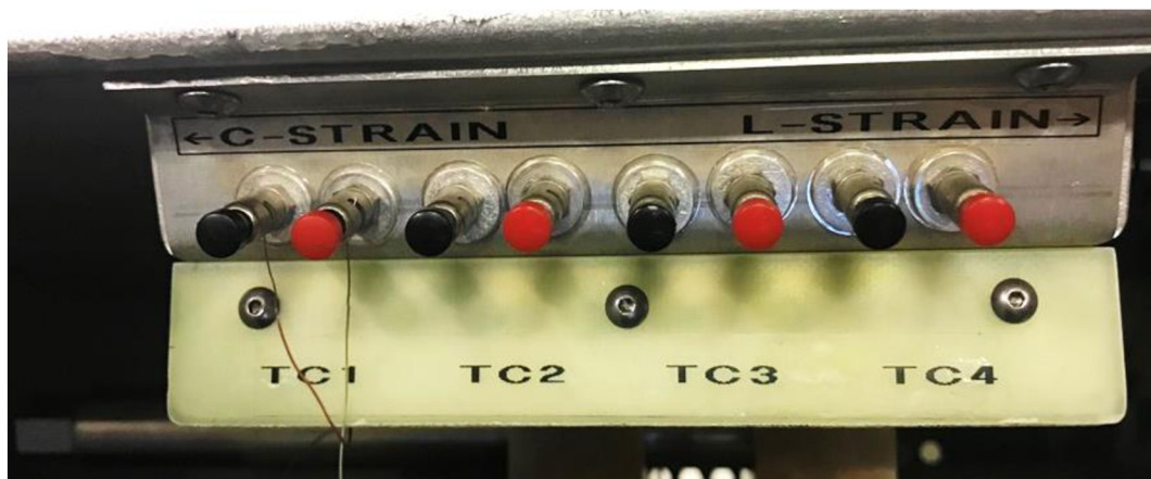
Obr. 2.11 Termočlánekové kanály přístroje Gleeble [19]
