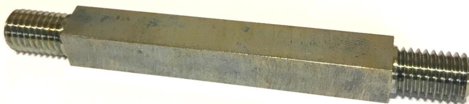
Obr. 3.8 Tvar vzorku použitého pro měření zbytkových napětí po aplikaci teplotních cyklů
