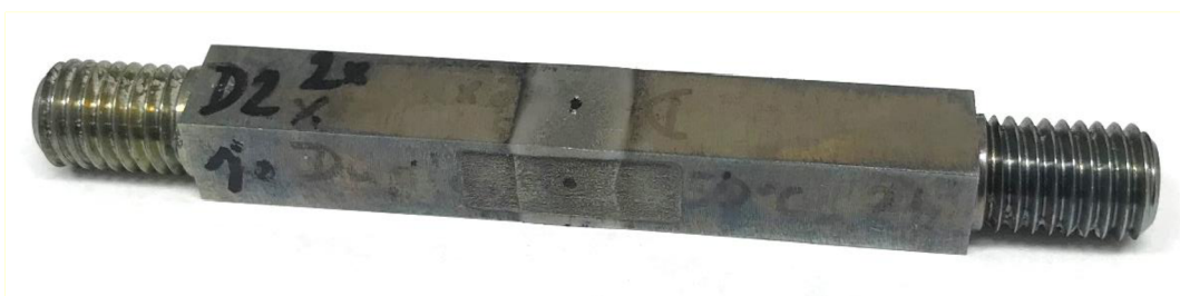
Obr. 3.12 Vzorek po aplikaci teplotního cyklu 1340 °C
