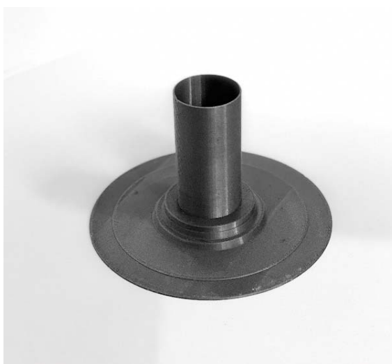
Obr. 26 – Hydraulický model vtoku Ø 32 mm (zdroj: archiv autora)
