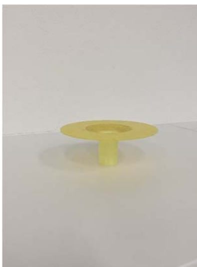
Obr. 25 – Hydraulický model vtoku Ø 25 mm (zdroj: archiv autora)
