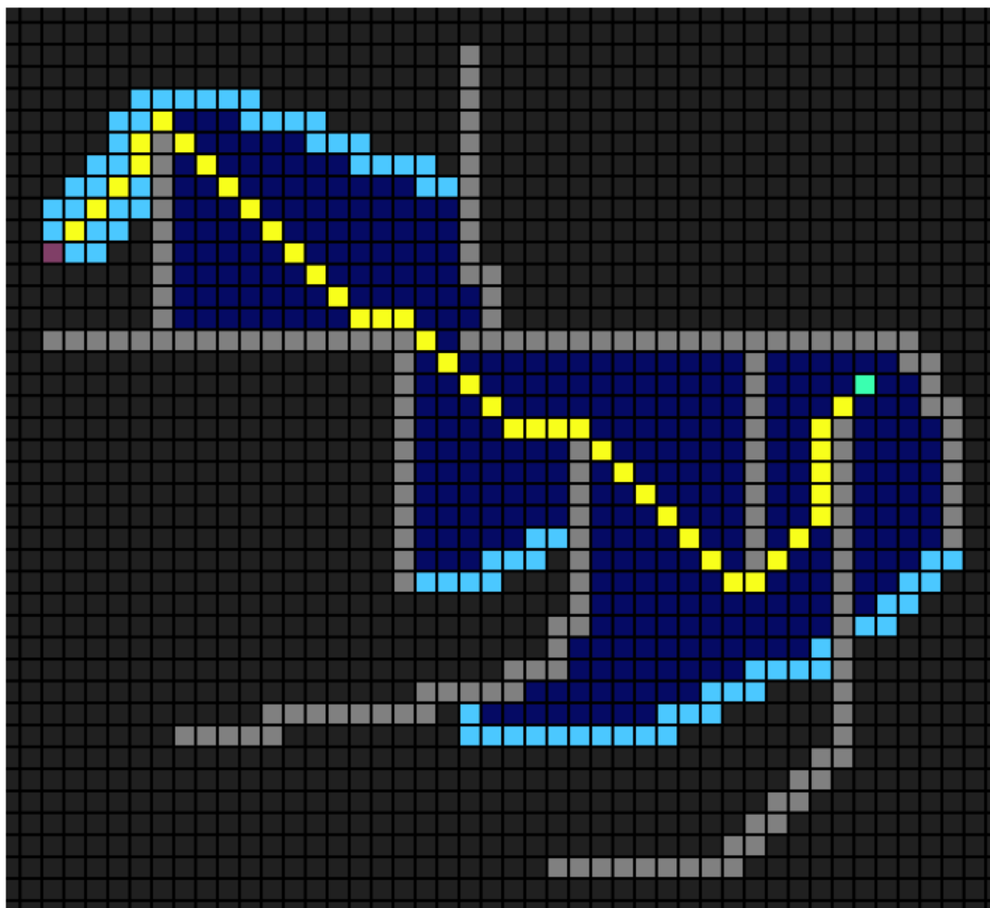
Obr. 8: Algoritmus A* – zelený start, červený cíl, žlutá cesta, tmavě modré prozkoumané uzly, světle modré uzly ze seznamu OPEN, šedé překážky, černé uzly neprozkoumané [25]
