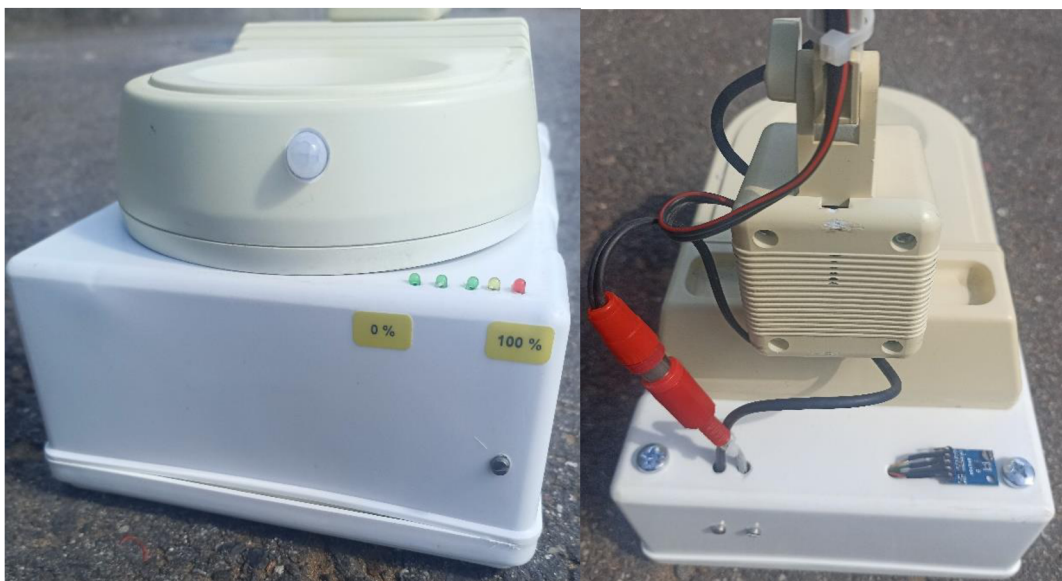
Obrázek 53: Svítidlo – pohled zepředu se signalizací a PIR senzorem (vlevo) a pohled zezadu se soumrakovým senzorem a napájecím konektorem (vpravo)
