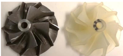
Obr. 1: Vlevo originální hliníkové kolo kompresoru a vpravo polymerové kolo [9].
