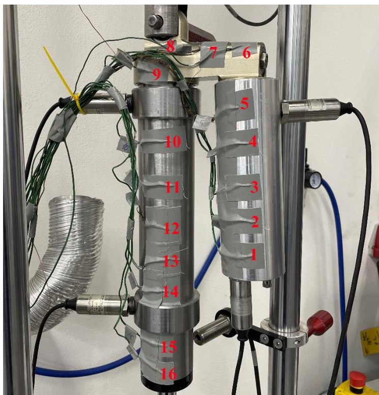
Obrázek 22: Pohled na tlumič během měření s označením jednotlivých termočlánků
