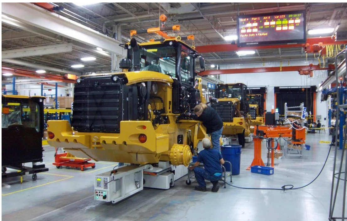
Obr. 1.9 Montážní AGV vozidlo
