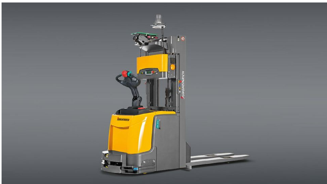
Obr. 2.8 Jungheinrich ERC 213a / 217a – Automatizovaný vysokozdvížený vozík Zdroj: [37].
