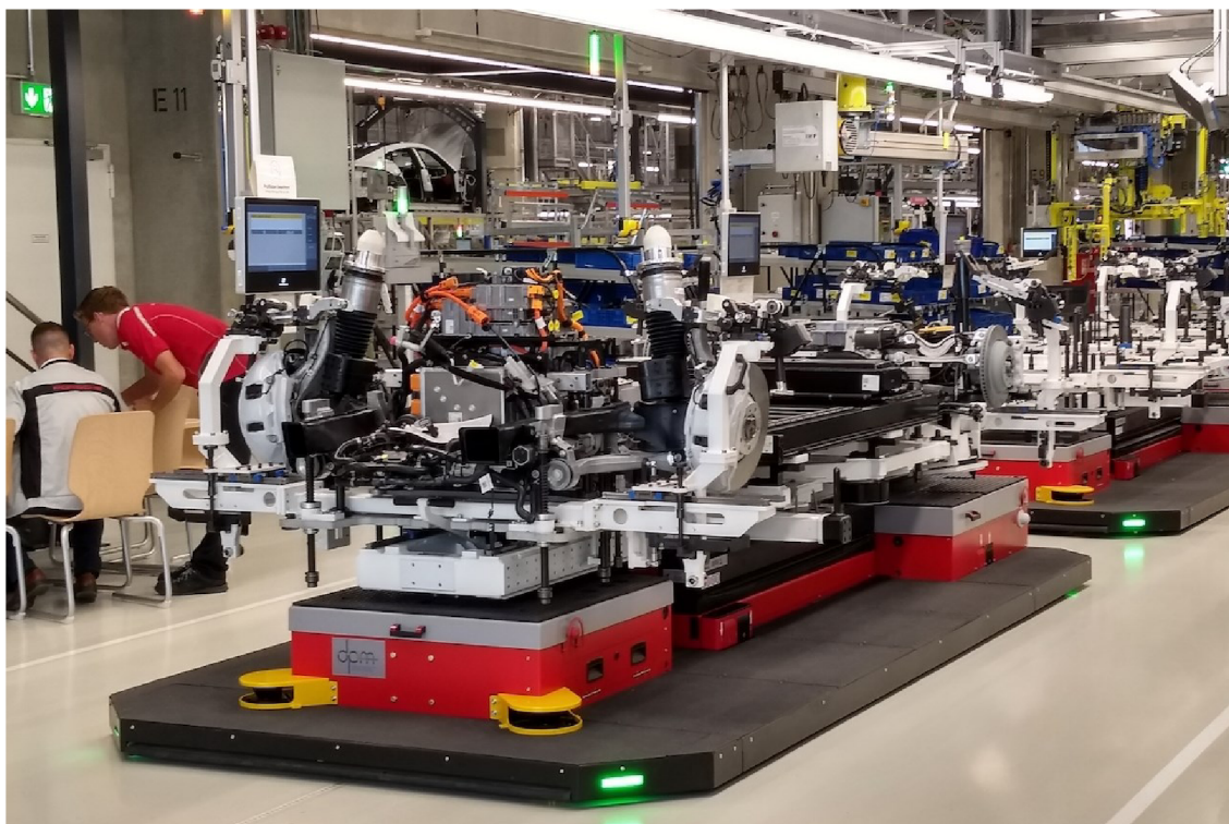
Obr. 2.2 Montážní AGV vozidlo ve společnosti Porsche
