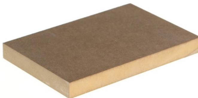
Obrázek 5: Polotvrdá deska DVD - MDF Zdroj: [ 13 Böh m, M., Re isner, J., Bomb a, J.. Materiály na bázi dřeva, 2012 ]
