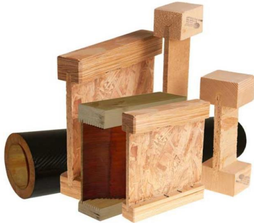
Obrázek 1: Speciální druhy nosníků – dutý kruhový nosník vyztužený uhlíkovými vlákny, I nosníky různých provedení se stojnami z OSB desek, vláknité desky a vlnité překližky Zdroj: [ 13 Böh m, M., Reisner, J., Bomb a, J.. Materiály na bázi dřeva, 2012]
