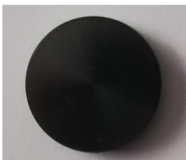
Obrázek 21: Vzorek s DLC COMP povlakem pro materiálovou analýzu.
