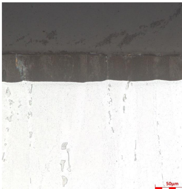
Obrázek 40: Příčný řez vzorku – místo 1 (anodizovaná vrstva).
