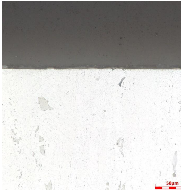
Obrázek 50: Příčný řez DLC povlaku – měř. bod 1
