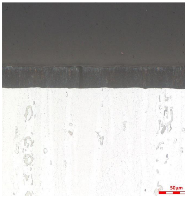
Obrázek 41: Příčný řez vzorku – místo 2 (anodizovaná vrstva s PTFE).
