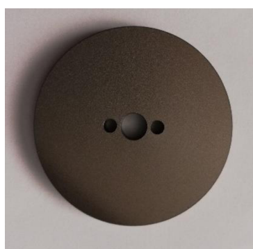
Obrázek 20: Vzorek s anodizovanou vrstvou pro tribologické experimenty.
