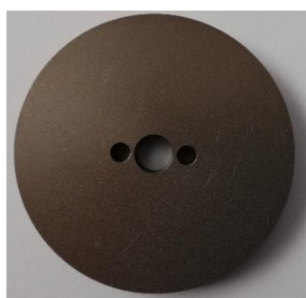
Obrázek 24: Vzorek s anodizovanou vrstvou a PTFE povlakem pro tribologické experimenty.
