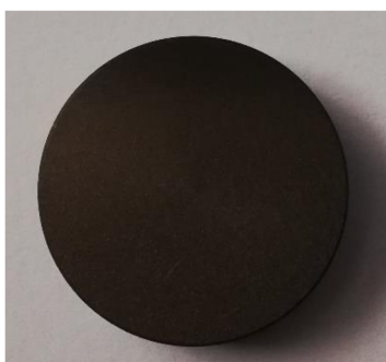
Obrázek 23: Vzorek s anodizovanou vrstvou a PTFE povlakem pro materiálovou analýzu.
