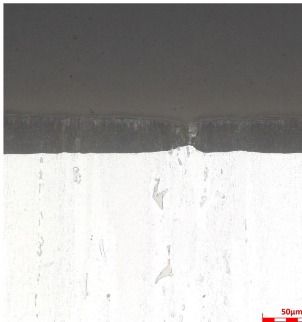
Obrázek 43: Příčný řez vzorku - místo 4 (anodizovaná vrstva s PTFE).
