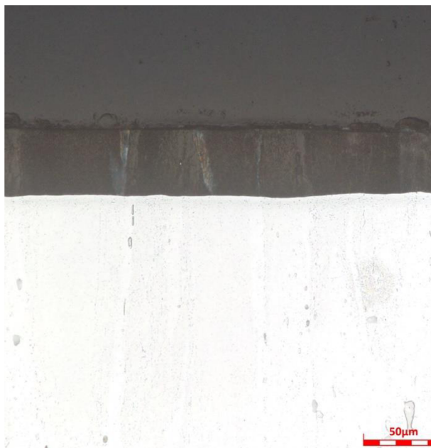
Obrázek 42: Příčný řez vzorku - místo 3 (anodizovaná vrstva).
