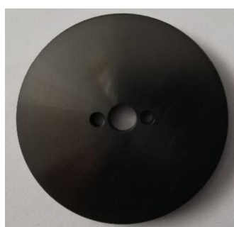
Obrázek 22: Vzorek s DLC COMP povlakem pro tribologické experimenty.
