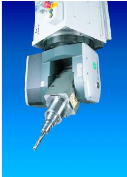
Obr. 13 Vidlicová hlava s pohonem osy A pomocí harmonické převodovky[9]
