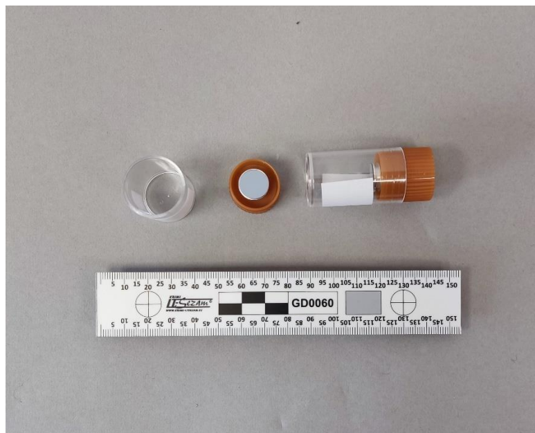
Obrázek č. 8 – kontejner s adhezí uhlíkovou vrstvou (zdroj: vlastní)
