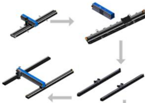
Obrázek 17 Rekonfigurace z lineárního na portálové provedení [21]
