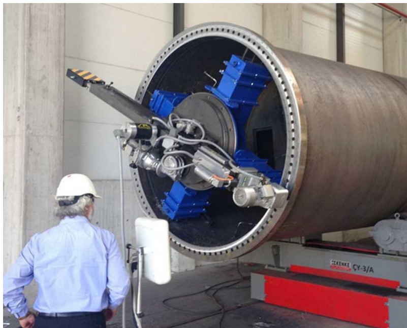
Obrázek 15 Frézovací stroj FMAX 4000 při vyvrtávání [20]
