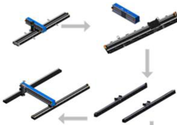
Obrázek 17 Rekonfigurace z lineárního na portálové provedení [21]
