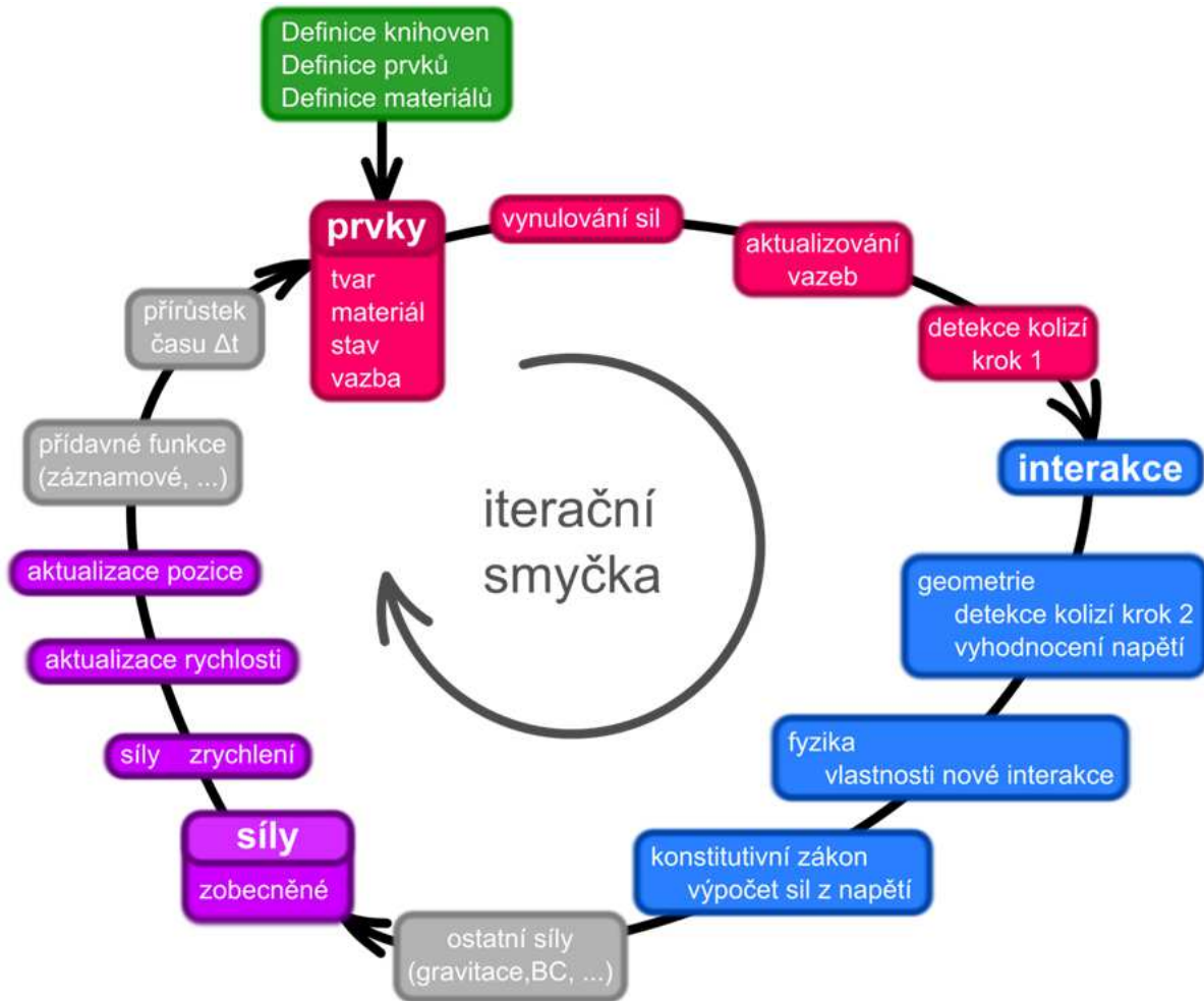
Obr. 5-7 Schéma iterační smyčky [14, s. 11]
