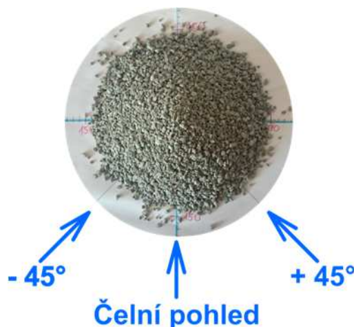
Obr. 3-3 Směry vyhodnocování sypného úhlu materiálu
