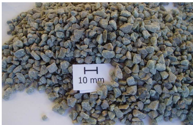
Obr. 3-1 Materiál pro zásyp odpichového otvoru
