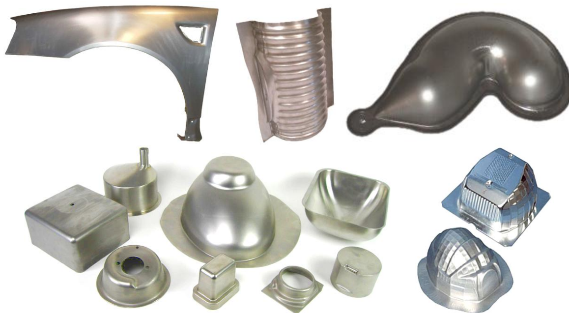
Obr. 1 Příklady tvarových skupin dílců hydroformování plechů [1], [2], [3], [4], [5]
