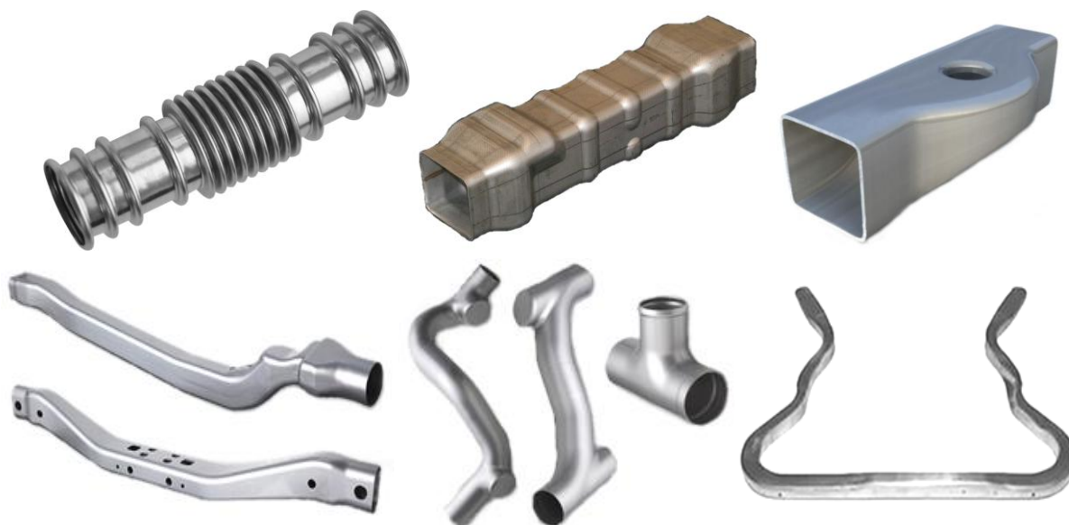
Obr. 15 Příklady tvarových skupin dílců trubkového hydroformování [29], [30], [31], [32], [33]
