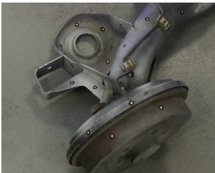
Obr. 4-7 Uložení tlumiče a pružiny na nápravě.
