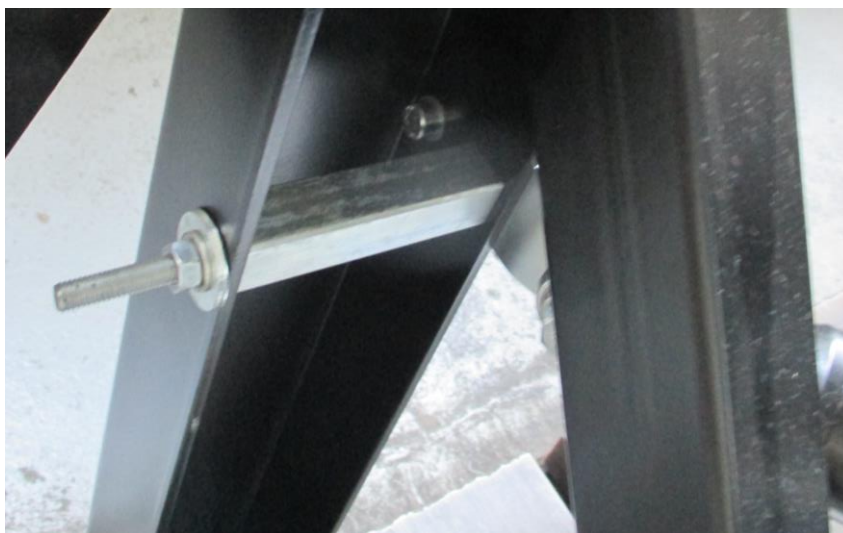
Obr. 6-2 Změna uchycení spodního ramena ke stojanu.
