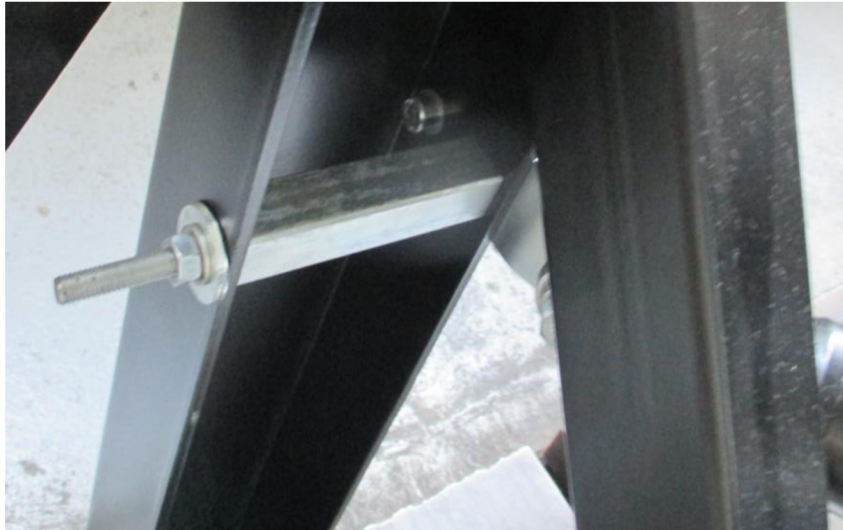
Obr. 6-2 Změna uchycení spodního ramena ke stojanu.
