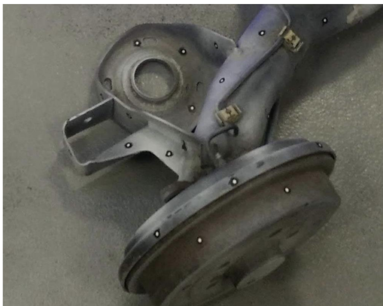
Obr. 4-7 Uložení tlumiče a pružiny na nápravě.
