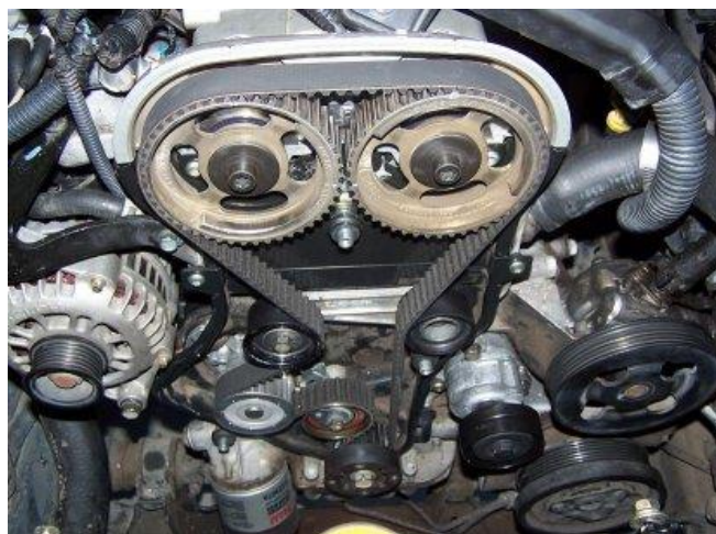
Obrázek 6 Ukázka rozvodového řemene u spalovacího motoru. Zdroj: davesautorepairutah.com
