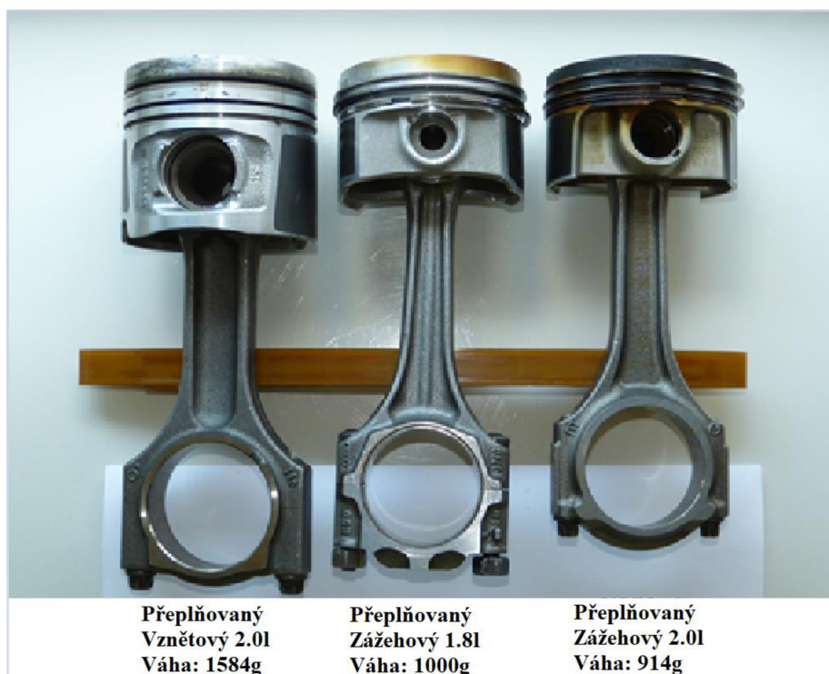
Obrázek 4 Porovnání pístu vznětového motoru (vlevo) a pístů ze zážehových motorů (vpravo). Zdroj:10.3390/lubricants7120105
