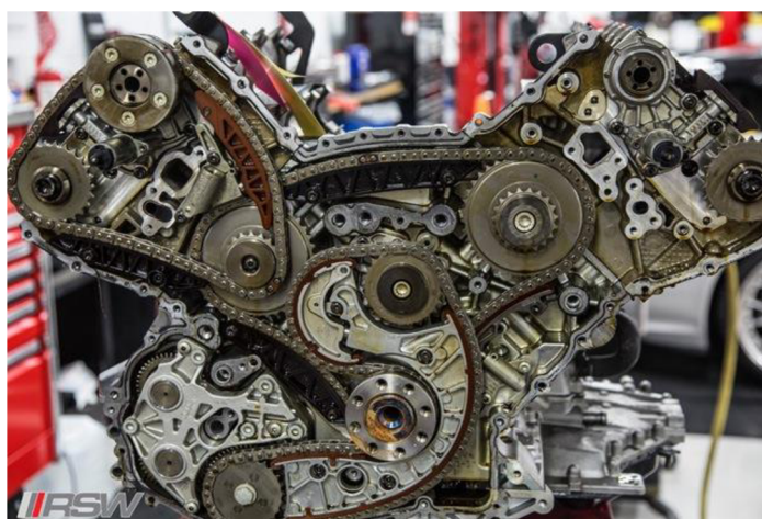
Obrázek 7 Ukázka motoru s rozvodovým řetězem. Zdroj: atlanticmotorcar.com
