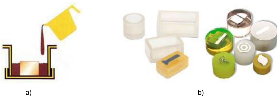
Obr. 22 Princip zalévání vzorku za studena (a), ukázka zalévacích forem a vzorků (b) [32]
