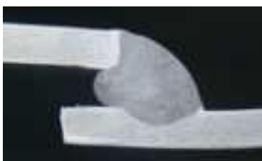
Obr. 13 Porovnání různých režimů na překládaném spoji hliníkových plechů [11]
