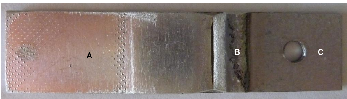
Obr. 43 Přetržený vzorek č. 9 bez korozní degradace
