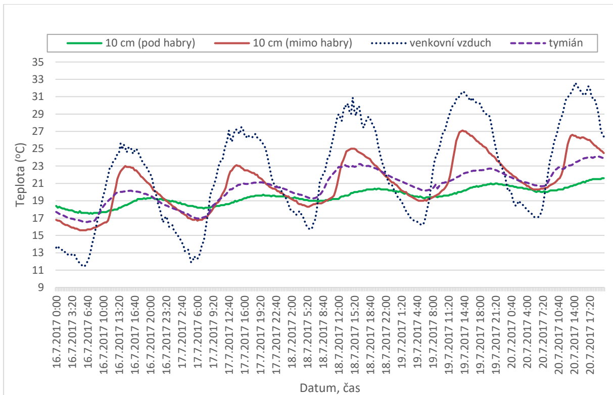
Obr. 4.72- Průběh teplot v substrátu v hloubce 10 cm pod habry a mimo habry ve srovnání s teplotou v porostu bylinek (tymián) těsně pod povrchem (16.7-20.7.2017)
