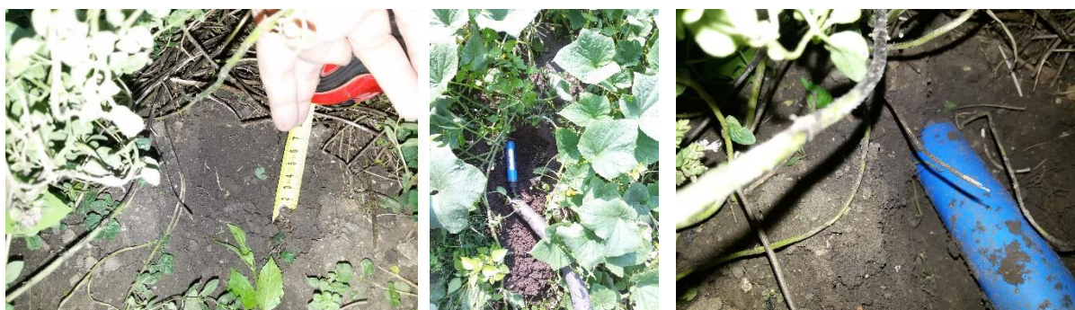
Obr. 4.81- Umisťování senzoru do porostu okurek do hloubky 5 cm
