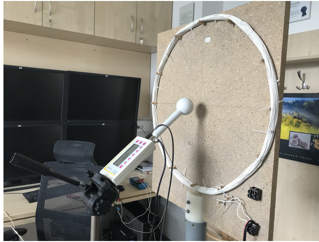
Obr. 2.31: Srovnávací měření dvou měřicích prostředí s magnetometrem Maschek ESM-100 v konfiguraci pro osu X.
