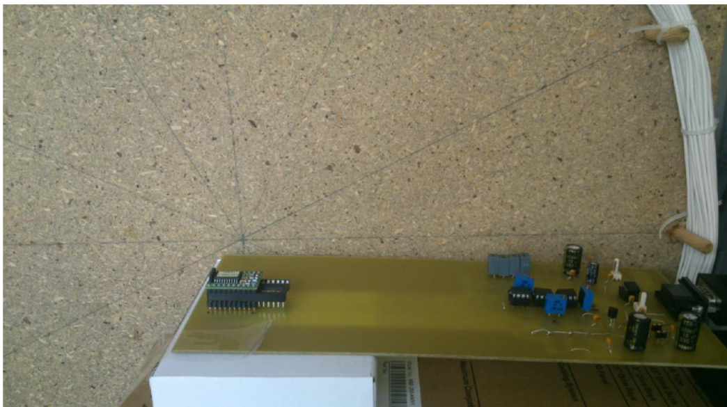
Obr. 1.3: Měřicí deska se snímačem HMC2003.
