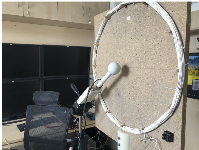
Obr. 2.32: Srovnávací měření dvou měřicích prostředí s magnetometrem Maschek ESM-100 v konfiguraci pro osu Y.
