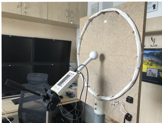
Obr. 2.31: Srovnávací měření dvou měřicích prostředí s magnetometrem Mashek ESM-100 v konfiguraci pro osu X.
