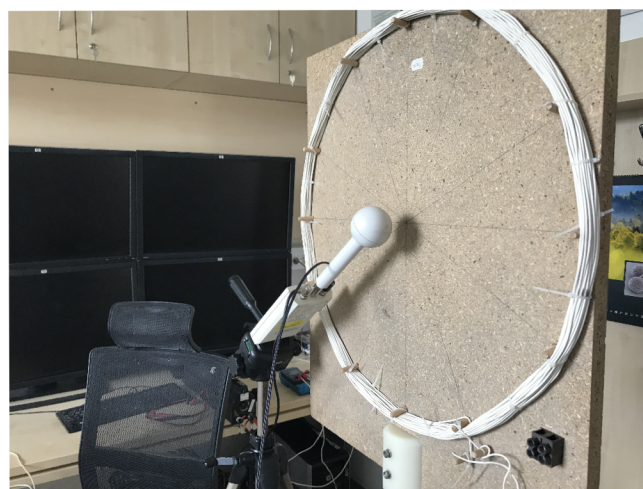
Obr. 2.32: Srovnávací měření dvou měřicích prostředí s magnetometrem Mashek ESM-100 v konfiguraci pro osu Y.
