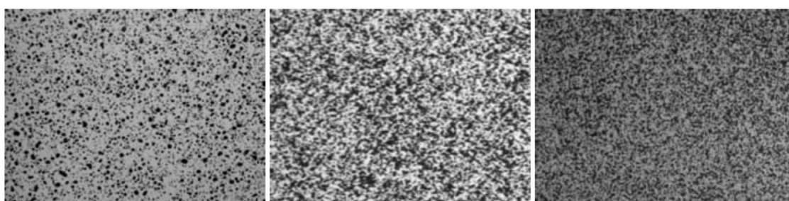
Obr. 2.1. Kontrastní stochastický vzor (Speckle pattern) [1]
