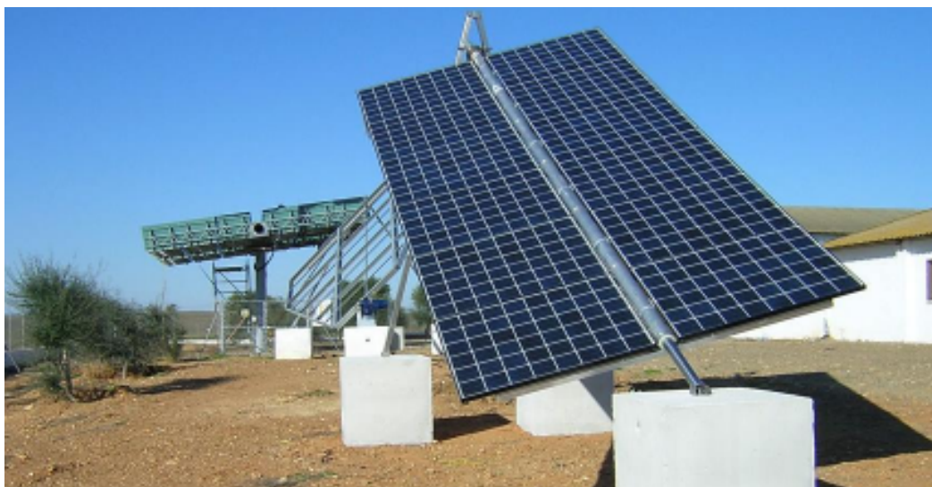
Obr. 2.5: Systém sledování slunce firmy Traxle. [9]
