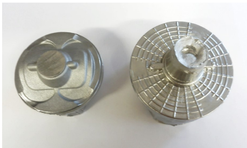
Obr. 3-2 Půdorysný pohled na odlitky pístů spalovacích motorů, vlevo je píst ze slitiny KS 1295; vpravo je píst ze slitiny KS 1275, určené pro sledování jejich struktury a kompaktnosti
