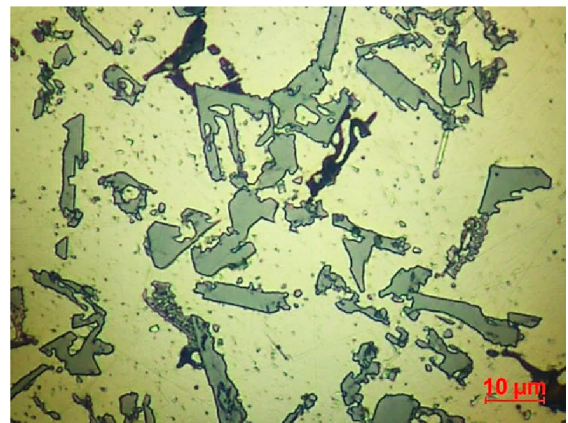
Obr. 3-18 Mikrostruktura hliníkové slitiny KS 1275 (AlSi12NiMg) pístu spalovacího motoru, zvětšení 1000 násobné, leptadlo kyselina fluorovodíková + voda
