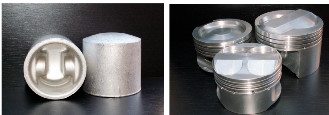
Obr. 2-15 Tvářené polotovary pro výrobu hliníkových pístů (vlevo) a písty po obrábění (vpravo) [9]
