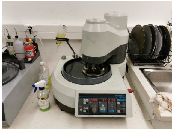
Obr. 3-12 Příprava vzorku pro metalografické pozorování z pístu spalovacího motoru
