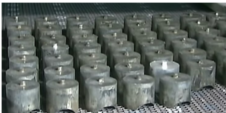
Obr. 2-14 Pohled na tvářené polotovary pístů spalovacích motorů [14]
