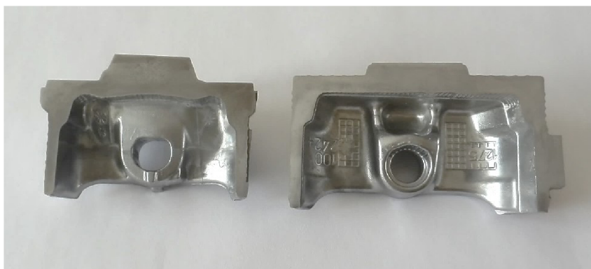
Obr. 3-10 Naleptaná struktura obou polovin pístů spalovacích motorů
