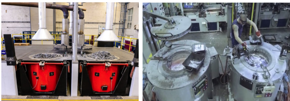
Obr. 3-7 Tavicí pece plynové a elektrické pro přípravu taveniny na výrobu pístů
