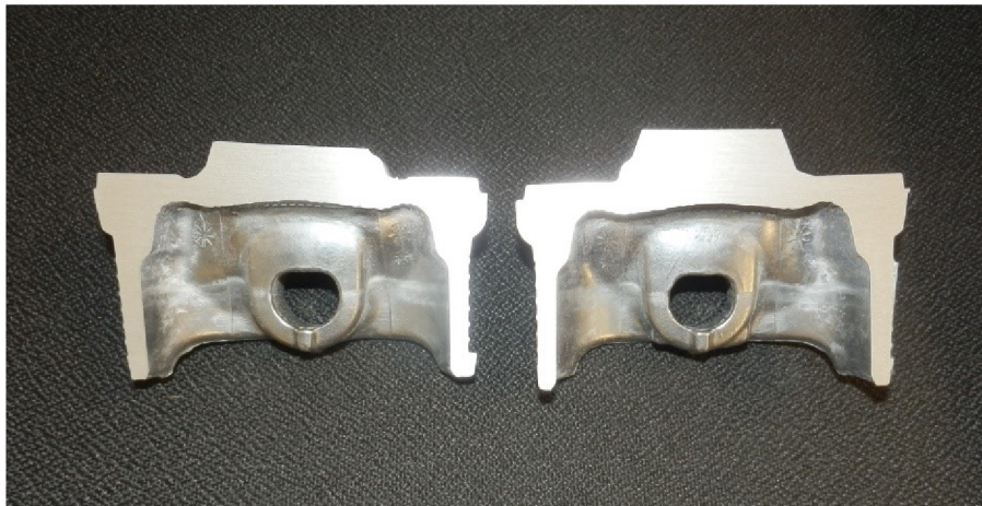
Obr. 3-8 Půlky pístu ze slitiny KS 1295 (AlSi12CuNi2 Mg)
