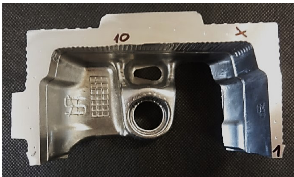
Obr. 3-28 Pohled na polovinu hliníkového pístu s místy, vtisky, po měření tvrdosti podle Brinella, slitina KS 1275
