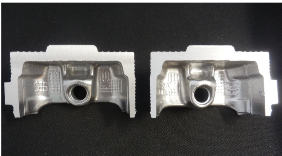
Obr. 3-9 Půlky pístu ze slitiny KS 1275 (AlSi12Ni Mg)
