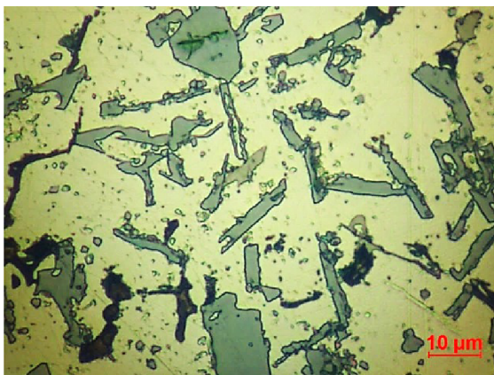
Obr. 3-18 Mikrostruktura hliníkové slitiny KS 1275 (AlSi12NiMg) pístu spalovacího motoru, zvětšení 1000 násobné, leptadlo kyselina fluorovodíková + voda
