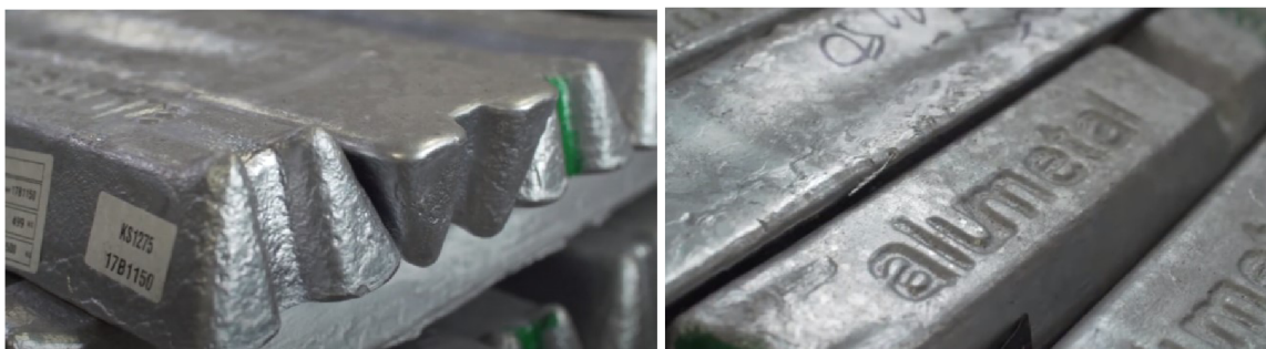
Obr. 3-3 Housky slitin KS 1275 a KS 1295 pro výrobu pístů spalovacích
