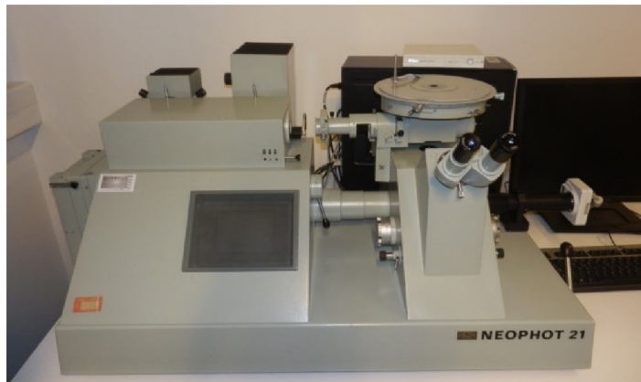
Obr. 3-14 Světelný mikroskop NEOPHOT 21 s kamerou a softwarem NIS Elementas AR
