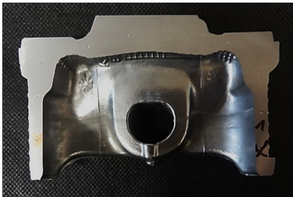
Obr. 3-29 Pohled na polovinu hliníkového pístu s místy, vtisky, po měření tvrdosti podle Brinella, slitina KS 1295
