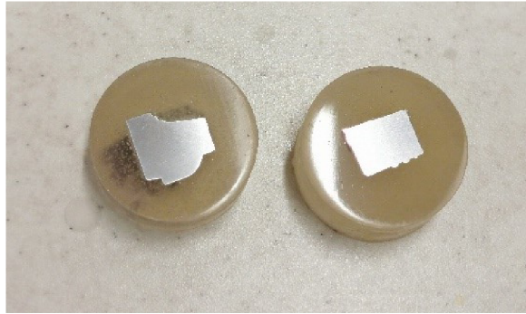
Obr. 3-13 Metalografické vzorky pro pozorování na světelném mikroskopu
