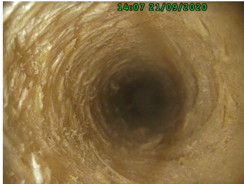
Obrázek 44: Snímek pořízený endoskopem – vazný trám, vazba č.10
