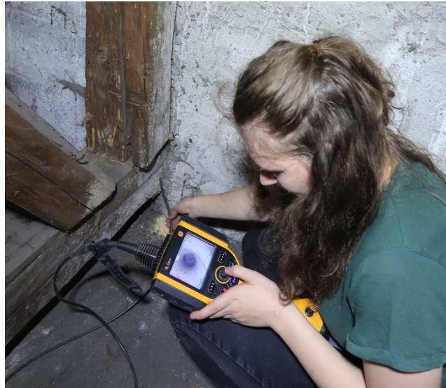
Obrázek 23: Příprava vrtu pro umístění kamery endoskopu
