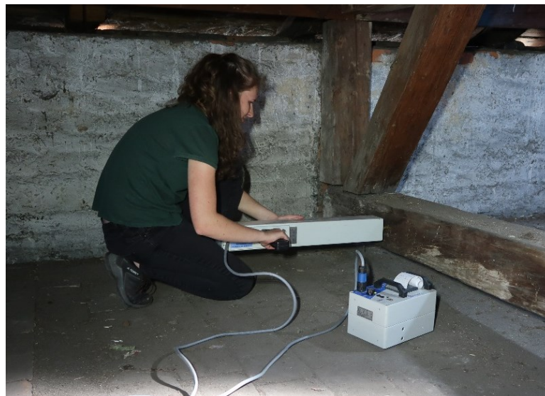
Obrázek 22: Odporové vrtání Resistografem
