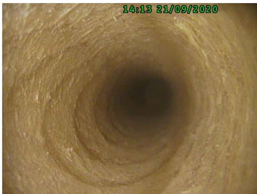
Obrázek 48: Snímek pořízený endoskopem – vazný trám, vazba č.16
