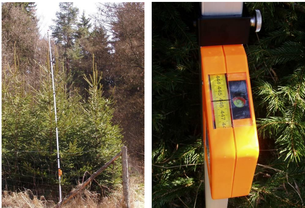
Obr. č. 17: Ukázka měření výšky stromků (foto: Hudínek 2010).
