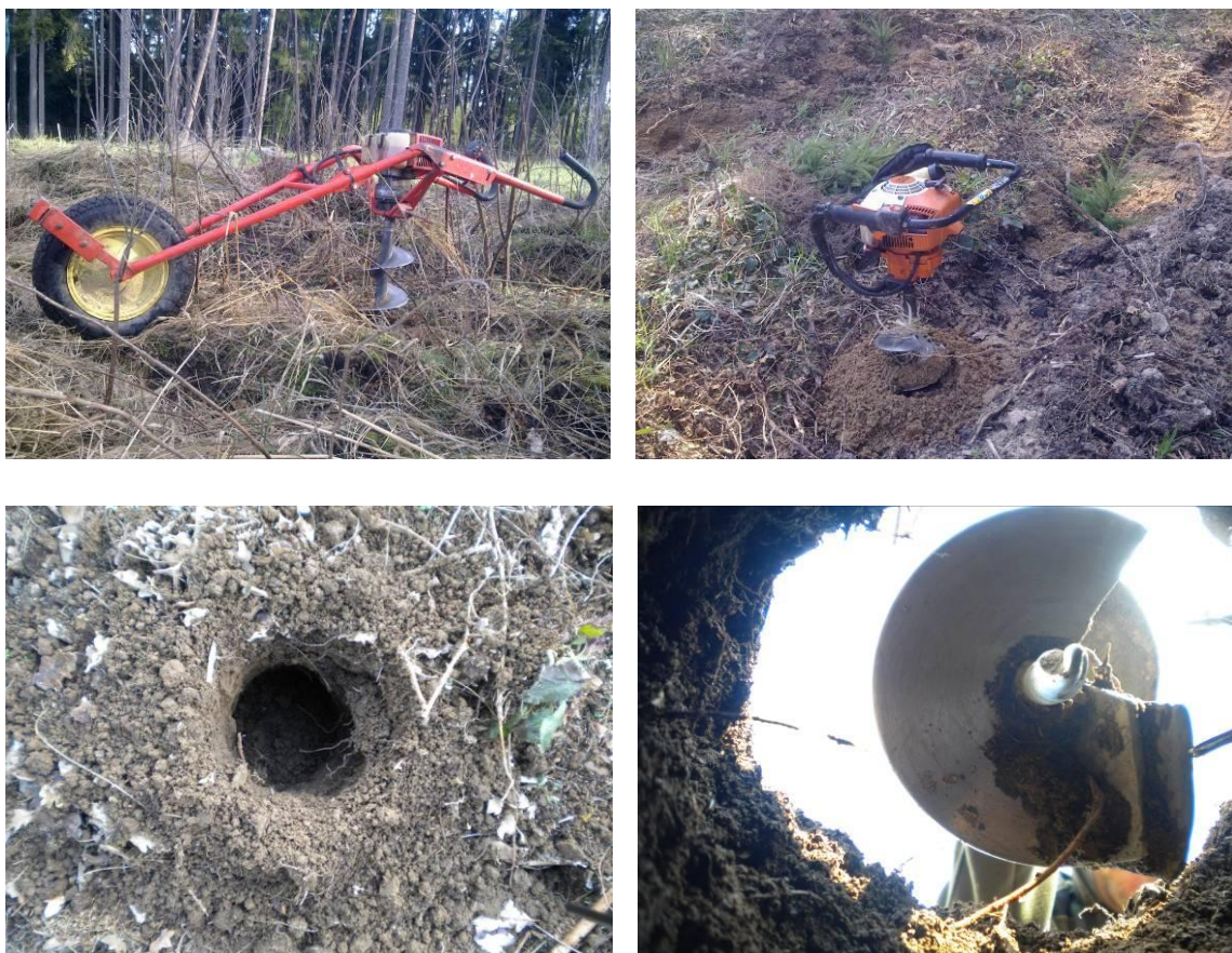
Obr. č. 6: Ukázka mechanizované sadby jednomužným jamkovým vrtákem (foto: Hudínek 2010).
