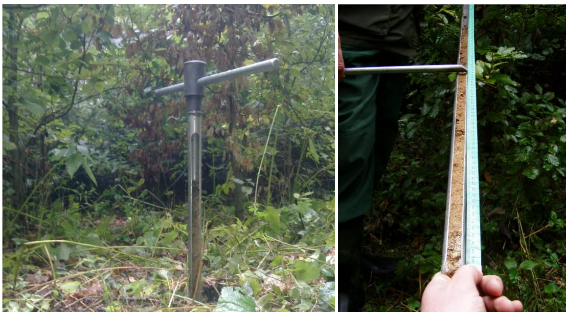
Obr. č. 16: Vlevo sondovací tyč, vpravo odebraný vzorek půdy (foto: Hudínek 2011).
