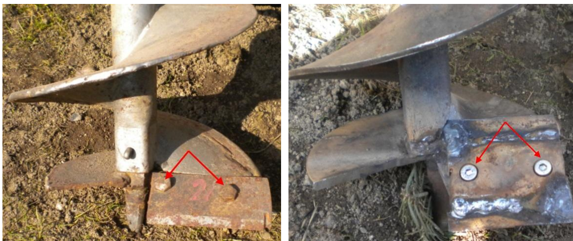
Obr. č. 30: Upevnění řezacího nože pomocí šroubů před úpravu a po úpravě (foto: Hudínek 2012).
