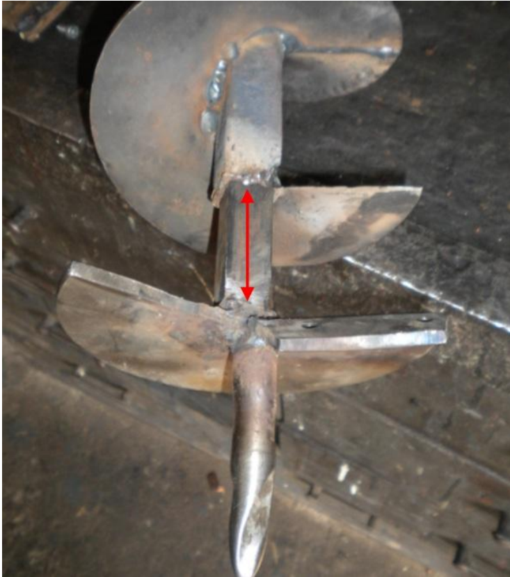
Foto č. 3: Ukázka výměnné korunky (foto: Hudínek 2012).
