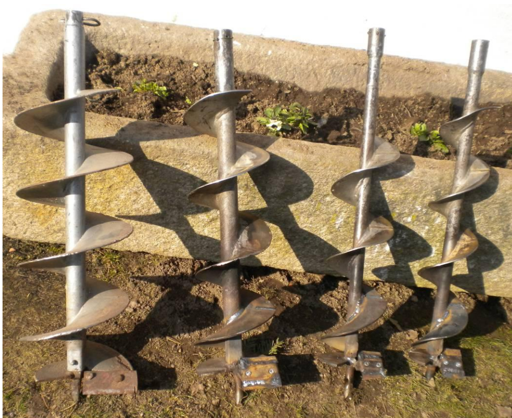
Foto č. 1: Půdní vrtáky, průměr 20, 15, 12, 10 mm (foto: Hudínek 2012).
