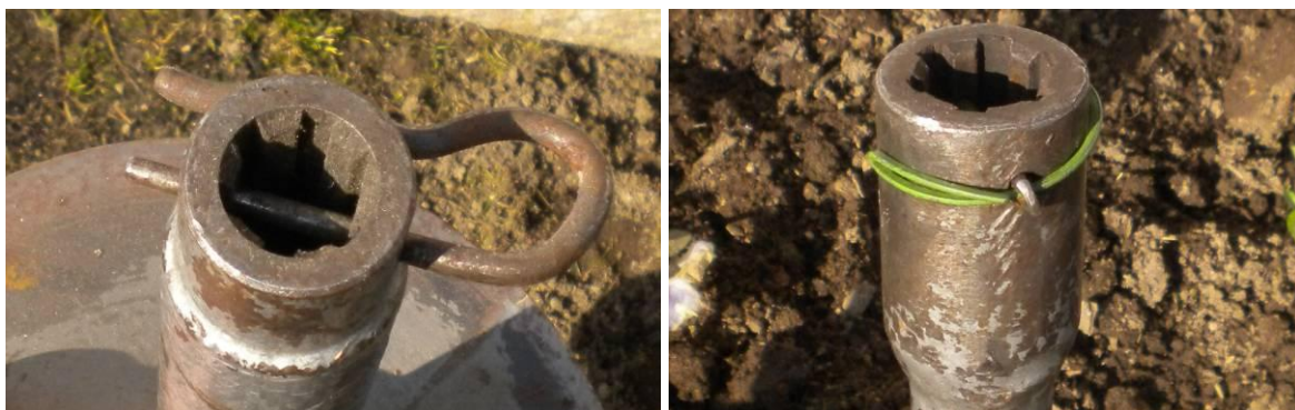
Obr. č. 31: Vlevo: originální závlačka, vpravo: upravená autorem (foto: Hudínek 2012).
