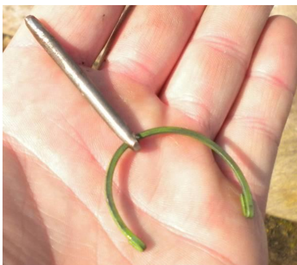
Obr. č. 32: Detail upravené závlačky (foto: Hudínek 2012).
