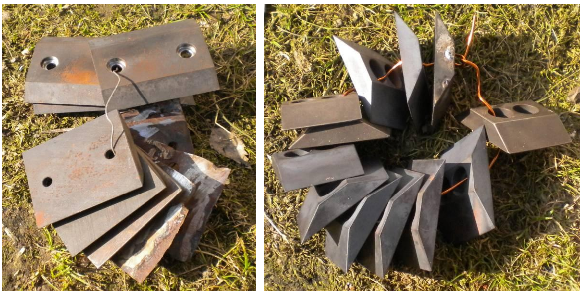
Foto č. 2: Ukázka výměnných řezacích nožů (foto: Hudínek 2012).
