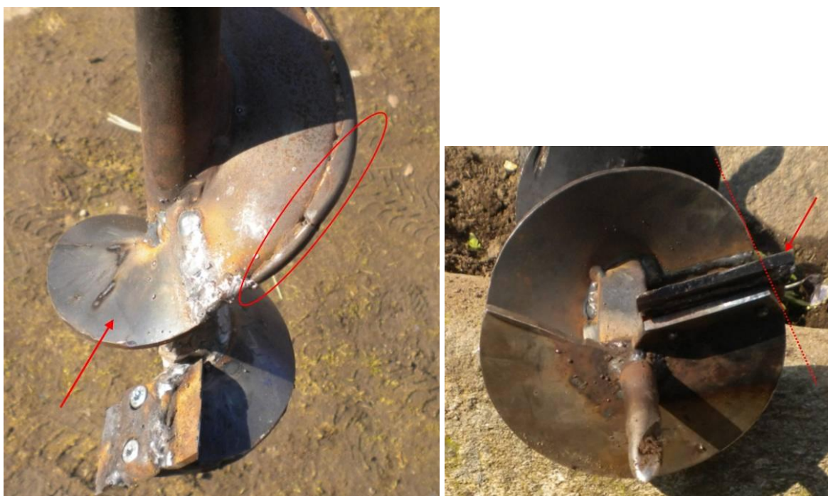
Obr. č. 29: Ukázky svépomocných úprav vrtáku v lesním provozu: Vlevo: navaření části spirály a speciálního „tvrdokovu“; vpravo: ukázka rozšíření řezacího nože cca o 1 cm (foto: Hudínek 2012).
