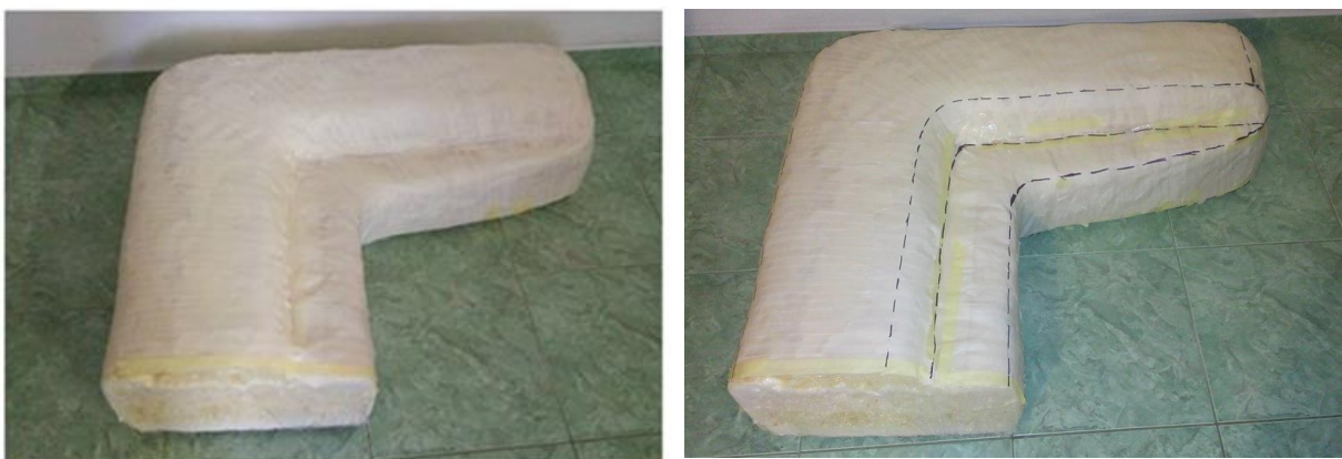
Obr. 54: Model airbagu obalený v papierovej lepiacej páske
