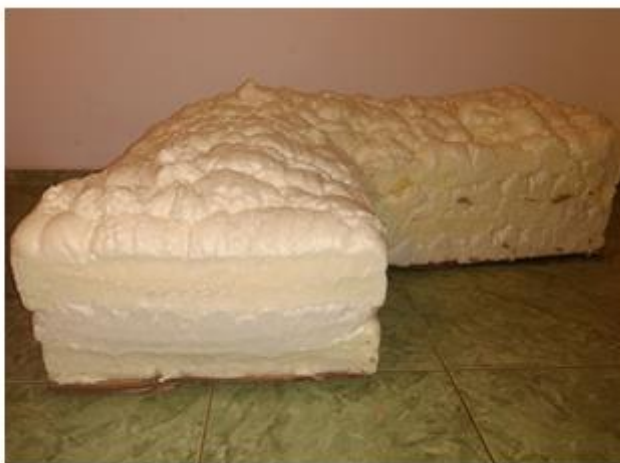
Obr.51: Vyplnená forma airbagu polyuretánovou penou
