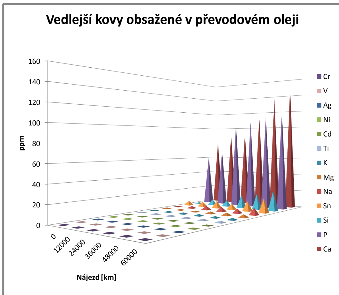
Obr. 18: Graf naměřených hodnot konstrukčních kovů v převodovém oleji [zdroj: autor]
