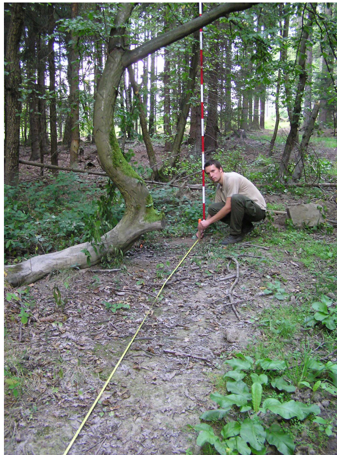
Obrázek 8: Měření a zajišťování staničních bodů
