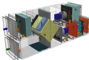
Obr. 38 - Specifikace vzduchotechnické jednotky – bazénová hala
